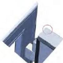
Hoja con chapa plegada de forma especial con cantos redondeados, con excelente rotura de puente térmico en PVC garantizando la máxima eficiencia energética. Alma de poliuretano inyectado a alta presión con densidad 45Kg/m<sup>3</sup> y coeficiente de conductividad térmica de 0,0220 W/m°C. Burlete perimetral de EPDM muy flexible.
