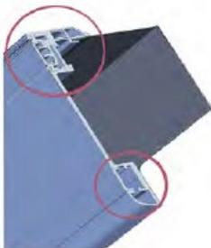
Marco con frontal de aluminio 6063 T5 lacado blanco con rotura de puente térmico especial en nylon 10/6 única en el mercado. Además de una gran robustez, su diseño especial le da una eficiencia energética que permite trabajar con temperaturas negativas por ambos lados de la puerta con total seguridad.
