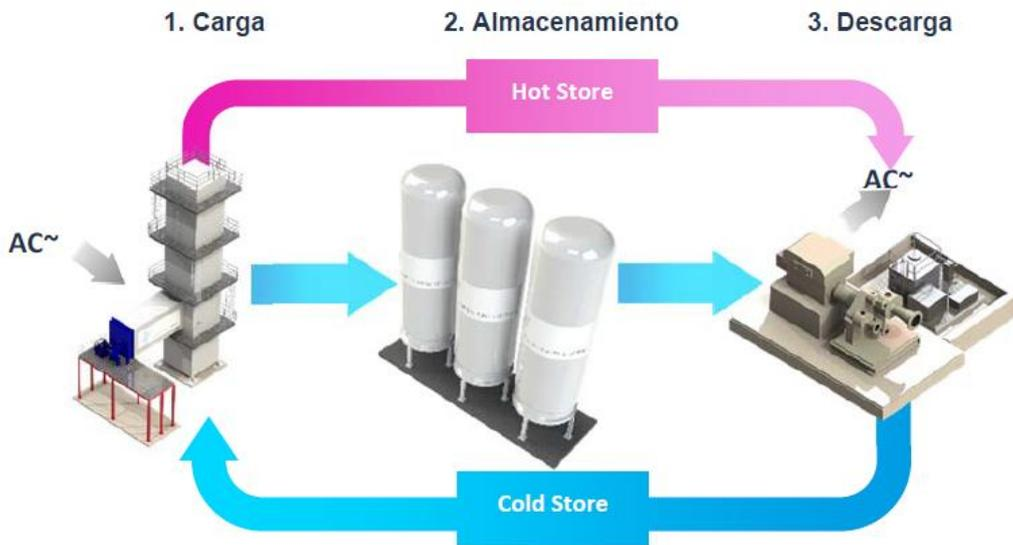
Figura 18: Esquema general I de funcionamiento de la CRYOBattery™ (Fuente: Highview Power)
