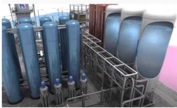
Figura 14: Almacenamiento de Aire Líquido (Fuente: Highview Power)
