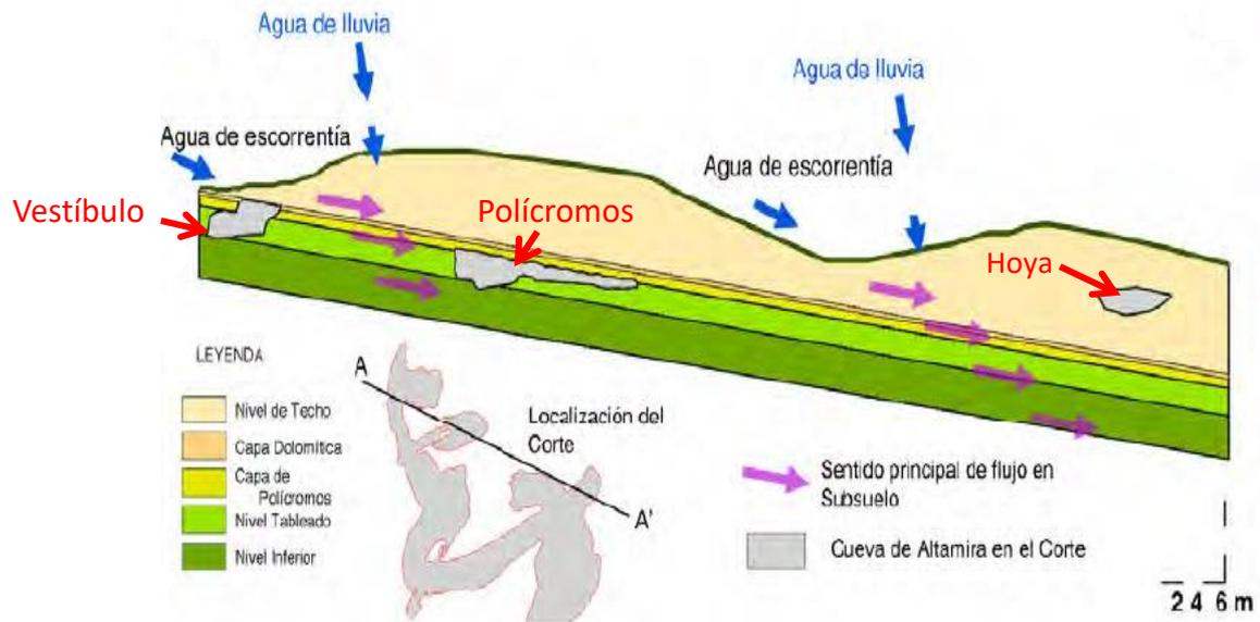
Figura 8. Simulación de la implicación directa de las aguas de lluvia y escorrentía en la cobertera de la cueva. Figura obtenida y editada del Informe CSIC 2005-2007, pag.45.
