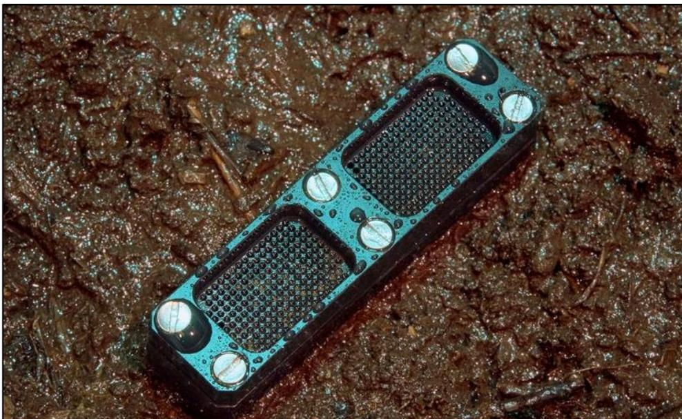
Figura 21. Ejemplo de un dispositivo “ichip” situado en el ambiente para el cultivo de microorganismos incultivables de suelo.
