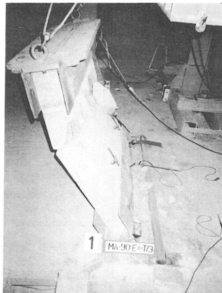
Fig. 14. Aspecto de la zona comprimida, en rotura, de murete armado ( $e=t/3$ )
