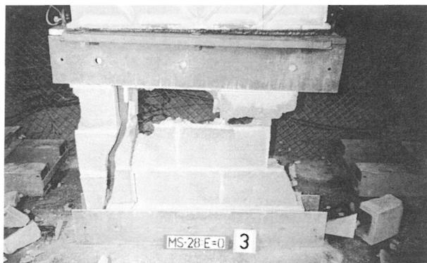
Fig. 13. Rotura de murete simple a carga centrada.
