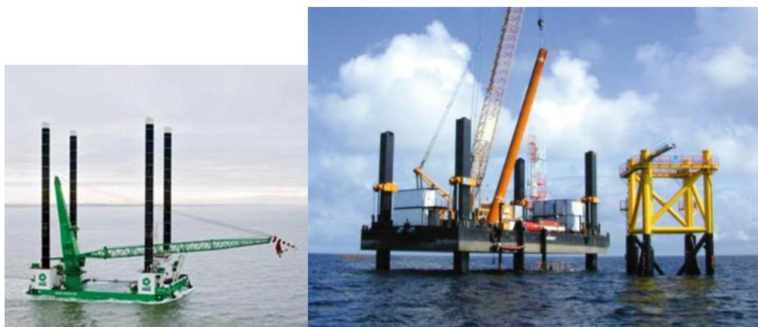
*Embarcación tipo jack-up ([www.ihcmerwede.com](http://www.ihcmerwede.com)) y plataforma offshore con grúa y pilote ([www.dewi.de](http://www.dewi.de))*
