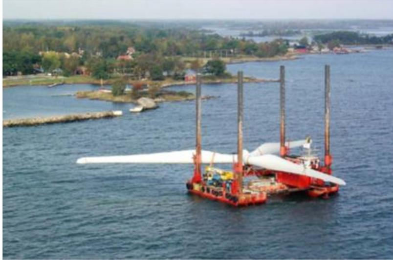
*Barco plataforma que se encargará de montar la estructura en la torre soporte*
