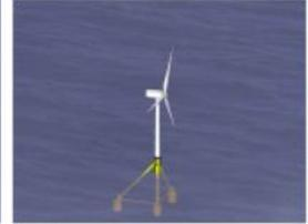
A lo que le seguirá un proceso de acoplamiento al fondo mediante una especie de cajones de succión que se introducirán al sustrato por sí solos mediante la diferencia de presiones que origina expulsando el agua que queda dentro del cajón.
