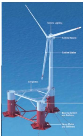
Plataforma flotante desarrollada por la empresa norteamericana Principle Power (Seattle USA) y la empresa Energías de Portugal. Equipado con un sistema de control de estabilidad mediante tanques de agua. Su peso es de 1080-1600 T y su volumen total con lastre es menor de 5500 T. Se amarra al fondo mediante cuatro cadenas en forma de catenaria.
