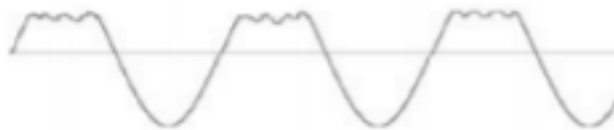
Figura 2.79-Truncamiento de la vibración debida a rozamiento [4]
