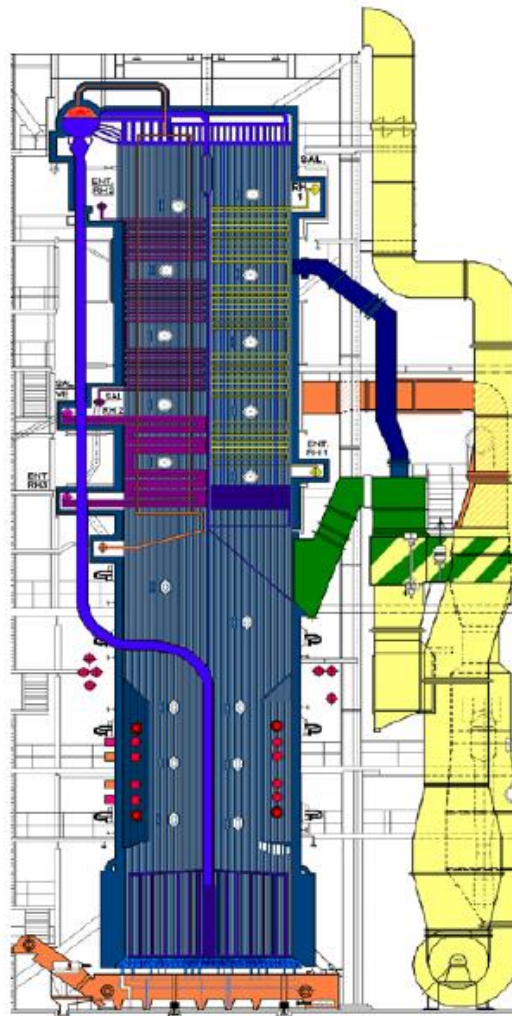
Figura 12 - Generador de vapor principal GNSP
