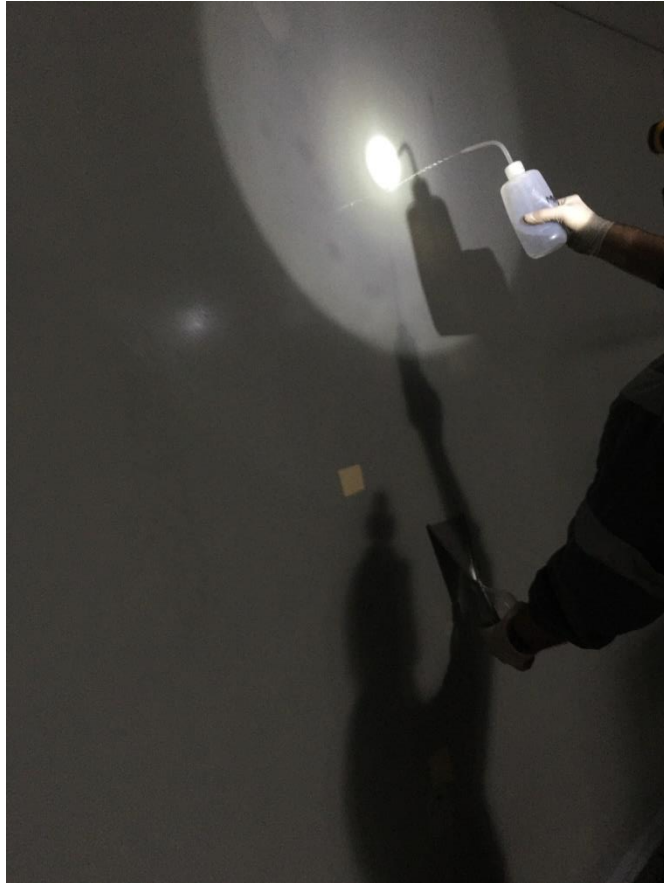
Ilustración 20: Oficial tomando muestras del mamparo de un tanque. Fuente: Elaboración propia
