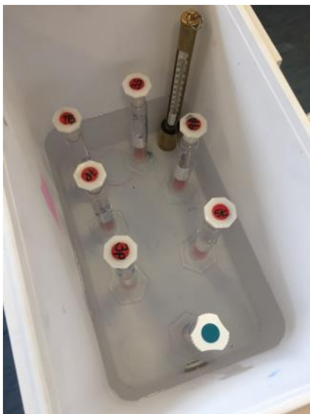
Ilustración 14: Test de permanganato. La muestra del tapón azul es la muestra maestra. Fuente: Elaboración propia
