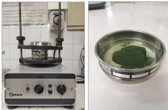
Figura 12. Tamizadora (izquierda) y tamices (derecha).
