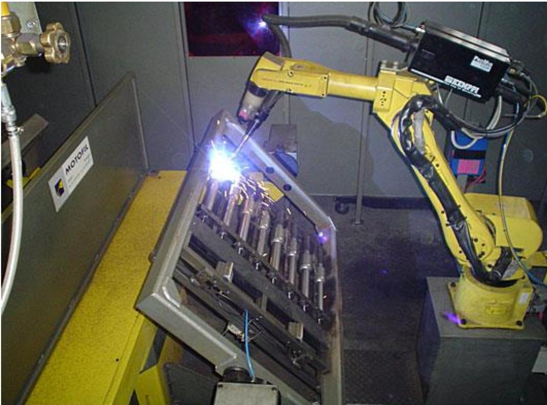
Figura 1.1 – Robot soldando piezas cilíndricas.
