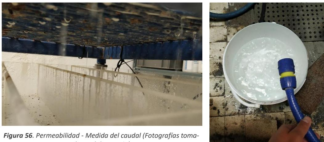
*Figura 56. Permeabilidad - Medida del caudal (Fotografías tomadas en laboratorio)*
