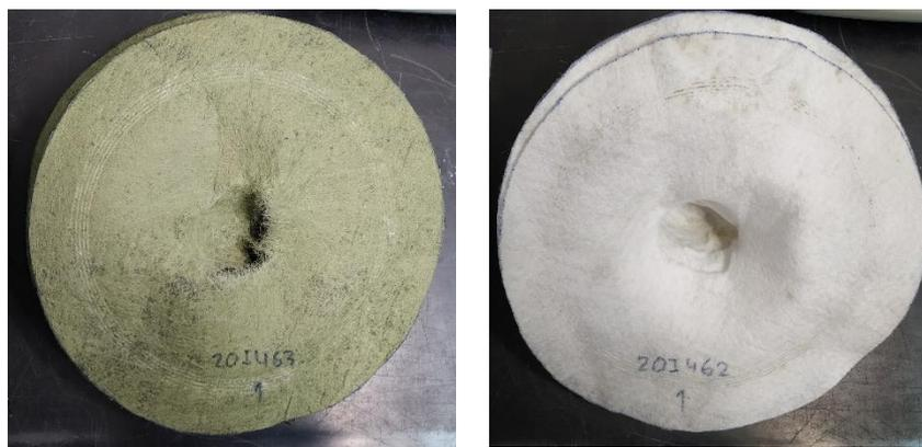
**Figura 63.** Aspecto tras desgarro de las muestras de G1 y G2 ensayadas a CBR
