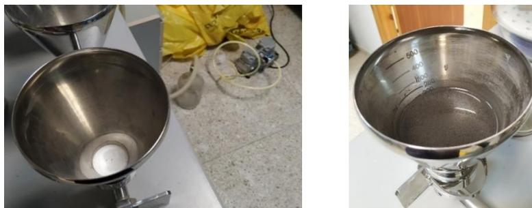
**Figura 51.** Filtrado ensayo abertura característica (Fotografía tomada en laboratorio)
