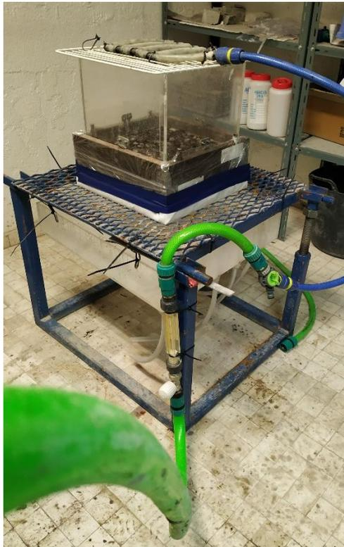
**Figura 55.** Sistema de permeabilidad sobre sección compuesta (Fotografías tomadas en laboratorio)
