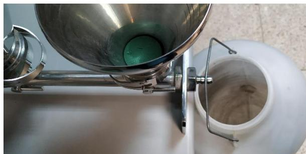
**Figura 66.** Agua que pasa a través de la geoespuma, sin presencia apreciable de sólidos
