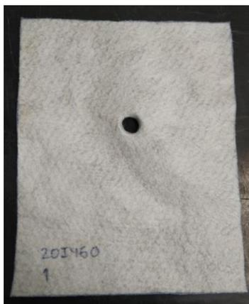
**Figura 47.** Probeta ensayada a caída de cono (Fotografía tomada en laboratorio)
