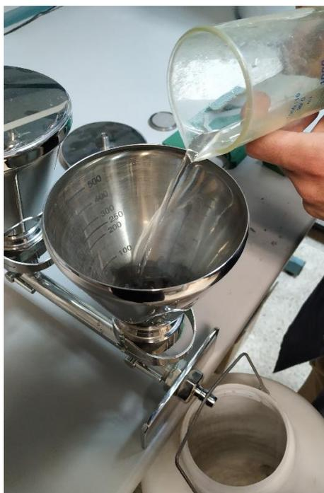
**Figura 65.** Ensayo abertura característica - Geoespuma (Fotografías tomadas en laboratorio)
