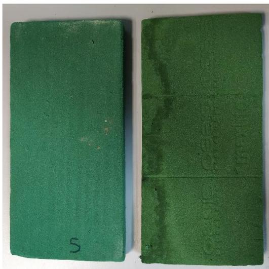
**Figura 68.** Diferencia de aspecto entre muestra en recepción (izda) y tras hidrólisis (dcha)
