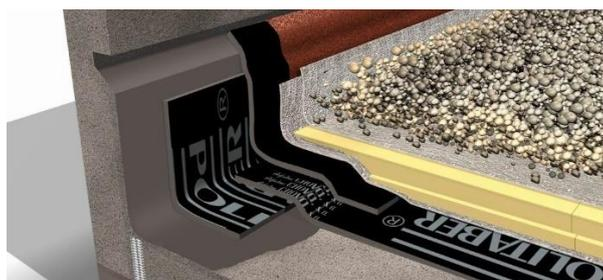
**Figura 17.** Detalle constructivo del solape de la capa filtrante (Fuente: chova.com, 2020)
