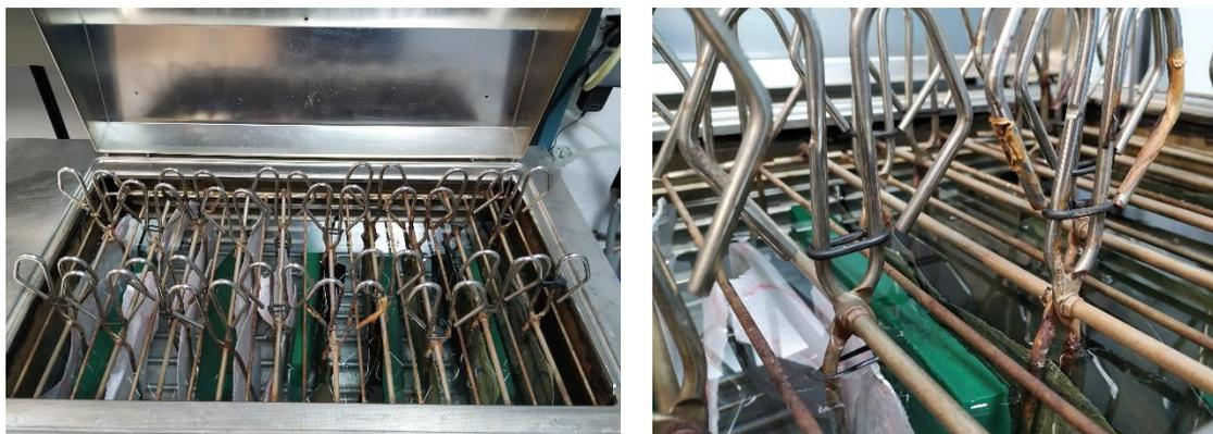
*Figura 52. Disposición general y detallada de las probetas sumergidas para hidrólisis (Fotografía tomada en laboratorio)*
