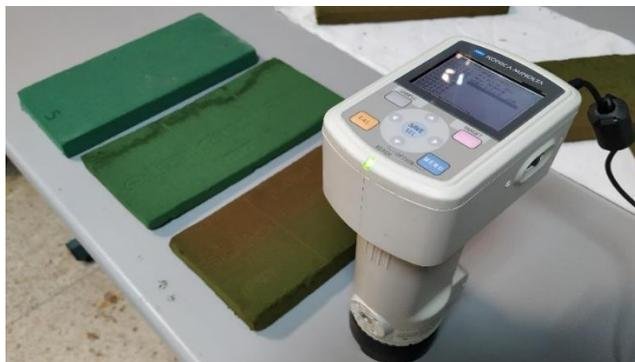
**Figura 67. Colorimetría – Hidrólisis (Fotografías tomadas en laboratorio)**
