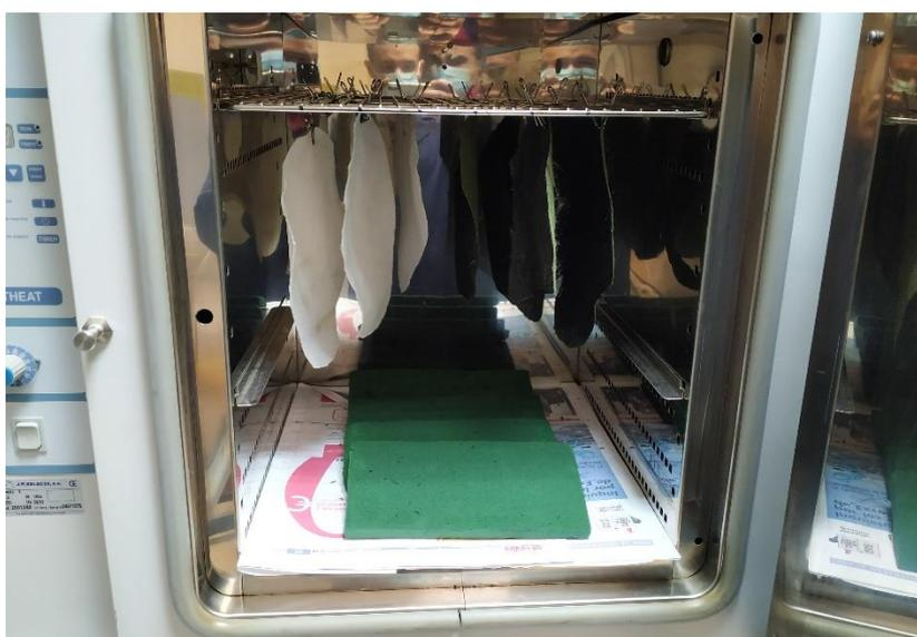
**Figura 53.** Disposición en el horno de las probetas sometidas a oxidación (Fotografía tomada en laboratorio)
