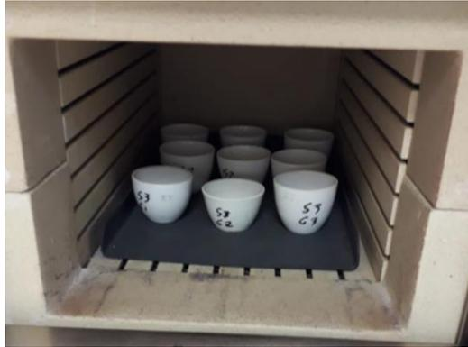
**Figura 57.** Calcinación a 550 °C en horno de mufla (Fotografía tomada en laboratorio)
