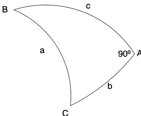
ILUSTRACIÓN 13: TRIÁNGULO ESFÉRICO RECTÁNGULO (FUENTE: EL AUTOR)
