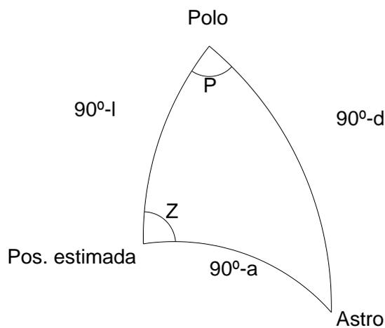
ILUSTRACIÓN 47: TRIÁNGULO DE POSICIÓN DEL EJERCICIO (FUENTE: EL AUTOR)
