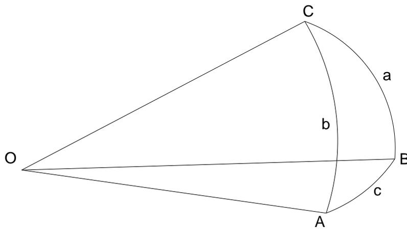
ILUSTRACIÓN 10: TRIEDRO CORRESPONDIENTE AL TRIÁNGULO ESFÉRICO (FUENTE: EL AUTOR)
