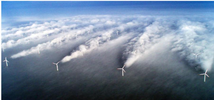
**Figura 25 Efecto estela de un aerogenerador offshore Dinamarca**
