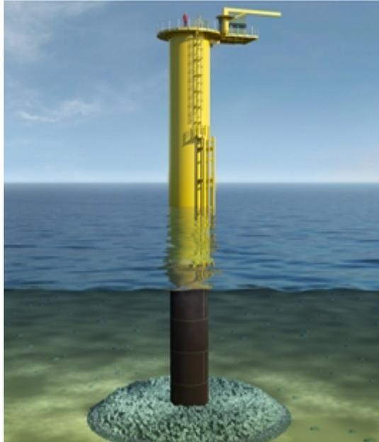
Figura 61 Detalle de la protección frente a la socavación para un monopilote [55]
