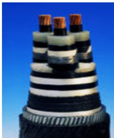
**Figura 13 Distribución espacial de cable submarino tripolar Cu de 220 KV, aislamiento XLPE y protección radial y longitudinal**
