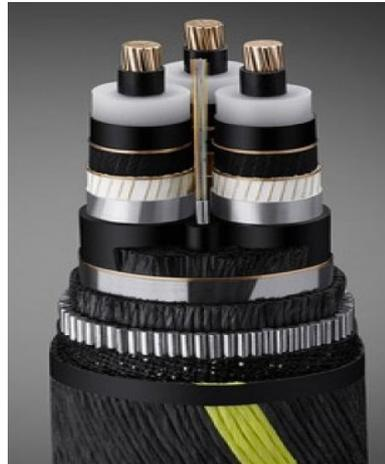
**Figura 10 Distribución espacial de las diferentes capas que componen la estructura del cable submarino de potencia modelo 2XS2YRAA 18/33 (36) KV [87]**
