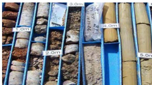
Figura 28 Muestras obtenidas mediante el empleo de saca testigos [22]
