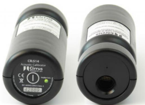
Figura 16: Ejemplo de pistófono
