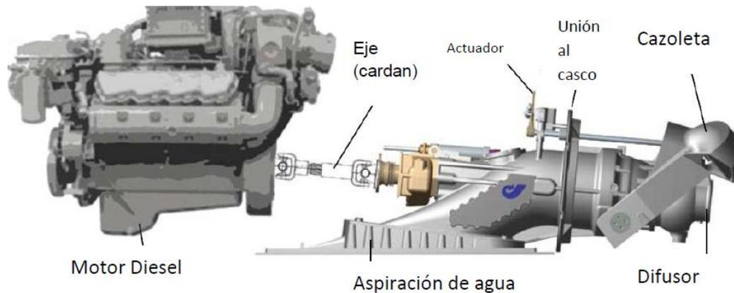
Figura 14. . Disposición convencional de un motor diesel acoplado a un sistema Wáter Jet.<sup>7</sup>
