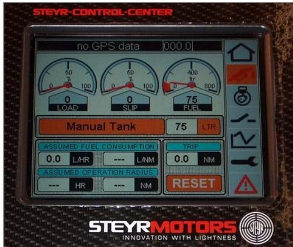
Figura 6. Panel de mando con gestión electrónica donde de modo táctil se puede modificar parámetros del motor de 184 kW; (Fabricante motores diesel Steyr ).
