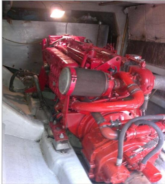
Figura 5. Actual motor principal del casco de Babor; embarcación "Paraíso del Mar".
