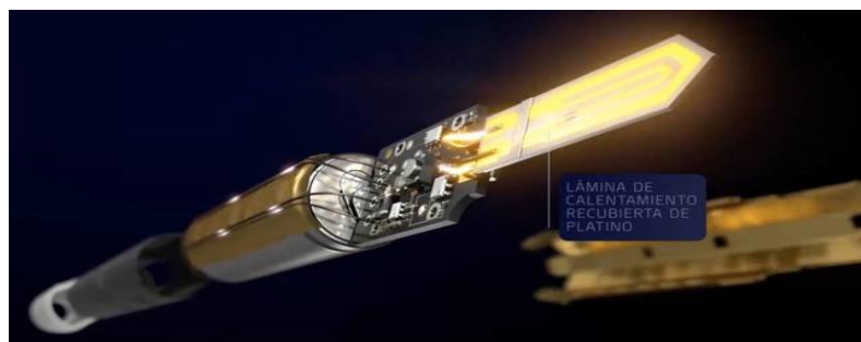
Figura 13. Lámina para calentamiento de tabaco recubierta de platino (Fuente: www.elconfidencial.com )
