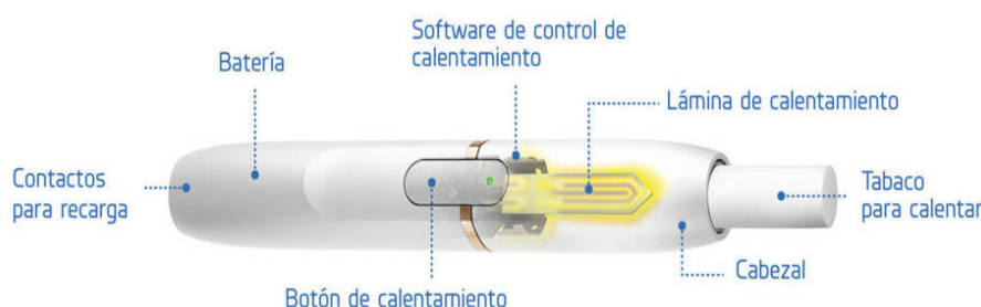
Figura 14. Estructura IQOS (Fuente: www.elconfidencial.com )
