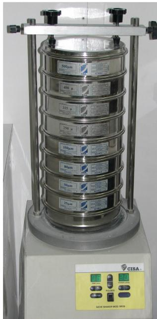
Figura 2.6. Tamizadora Mod. RP09 Marca CISA (laboratorio de HISBALIT).
