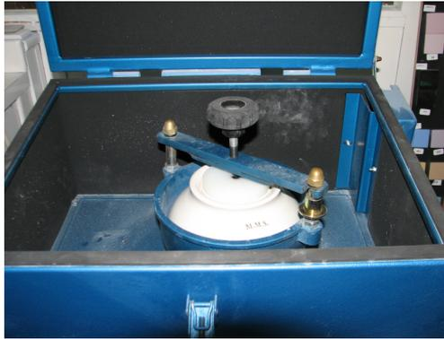
Figura 2.5. Molino de bolas Marca MMS (laboratorio de HISBALIT).
