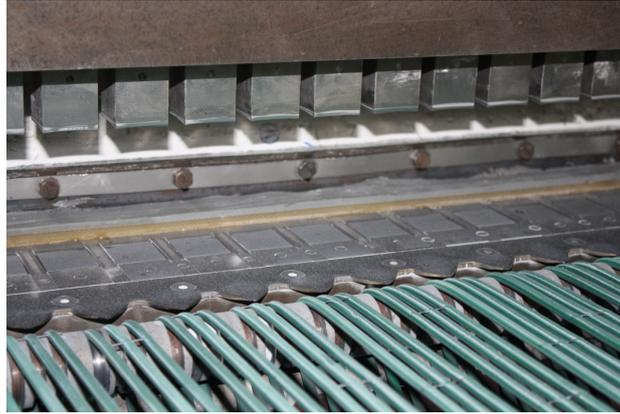
Figura 2.3. Detalle de los machos y hembras de las prensas.
