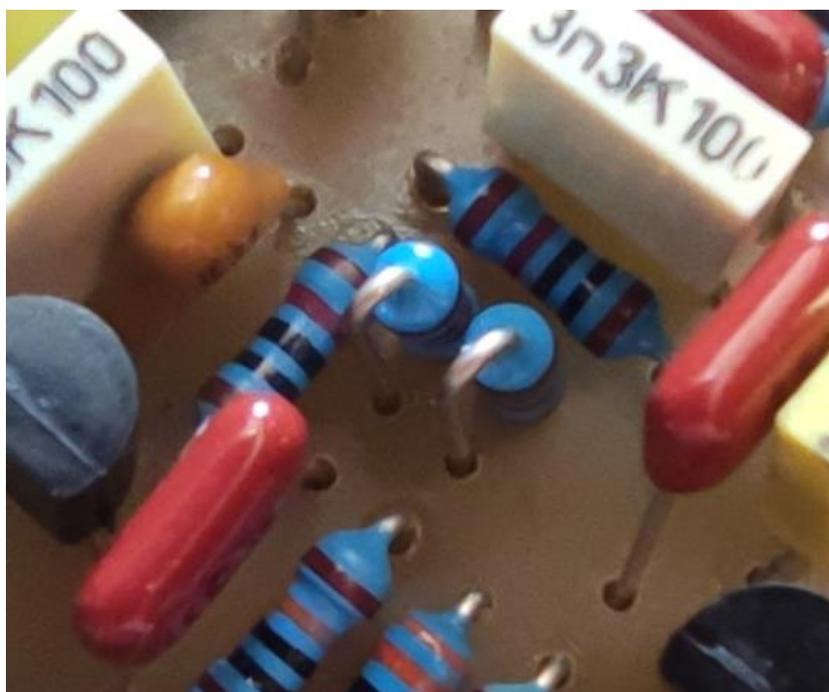
**Figura 41: Resistencias montadas en vertical en el circuito**
