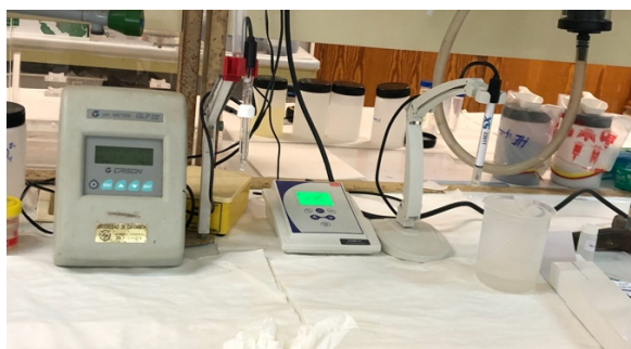
Figura 11. Equipos de medición (conductivímetro y pH-metro).
