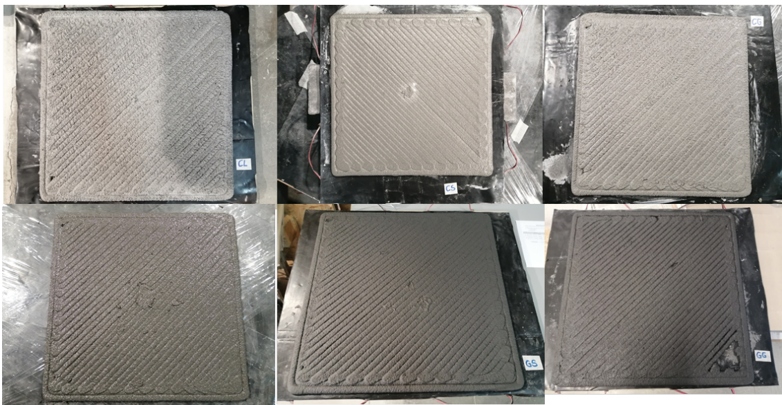
Figura 6. Productos 3DPare fabricados mediante impresión 3D.
