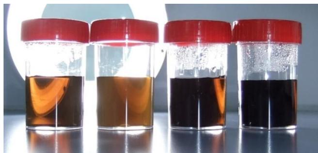
**Figura 2.1. Imagen con cuatro muestras de grafeno oxidado a partir de GPSI en agua a la misma concentración tras la exfoliación del grafito oxidado con variaciones en el porcentaje de amplitud de señal del equipo de ultrasonidos. De izquierda a derecha 10, 20, 30 y 40% de amplitud.**
