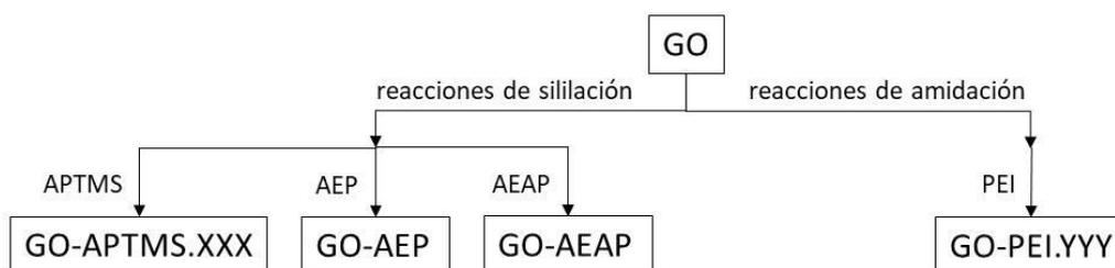
**Figura 4.34. Esquema general sobre las distintas amino-funcionalizaciones del óxido de grafeno llevas a cabo en la presente tesis.**
