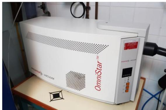
**Figura 2.16.** Imagen de espectrómetro de masas utilizado en este trabajo.
