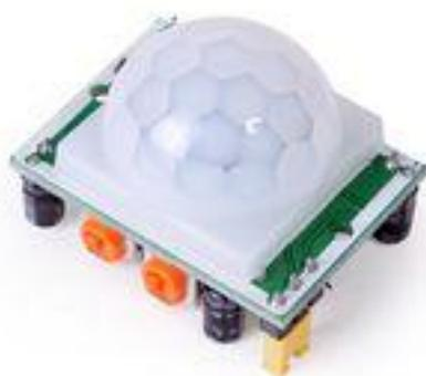
*Fig79. Sensor de movimiento PIR*
