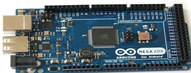
Fig69. Placa de arduino MEGA ADK
