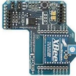
Figura 3.6 Escudo XBee
