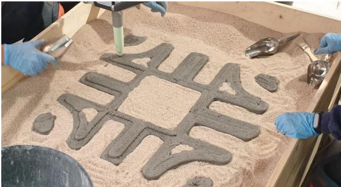
*Ilustración 10: Impresión en 3D de un arrecife artificial, en la zona de agujeros intermedios, mediante la impresora tipo delta modelo 'WASP 3MT' en la Universidad de Cantabria. Fuente: Propia.*
