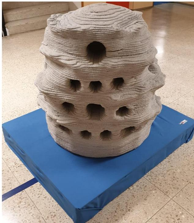
*Ilustración 14: Arrecife artificial impreso en 3D mediante la impresora tipo delta 'WASP 3MT' en la Universidad de Cantabria. Modelo: Random Big - Cement Limestone. Figura 2. Fuente: Propia.*
