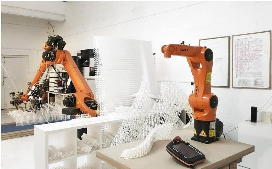
*Ilustración 1: Brazo robot imprimiendo una pieza de plástico en 3D. Fuente: [www.3ders.org](http://www.3ders.org)*
