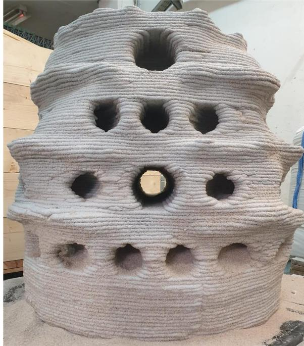
*Ilustración 13: Arrecife artificial impreso en 3D mediante la impresora tipo delta 'WASP 3MT' en la Universidad de Cantabria. Modelo Random Big - Cement Limestone. Figura 1. Fuente: Propia.*
