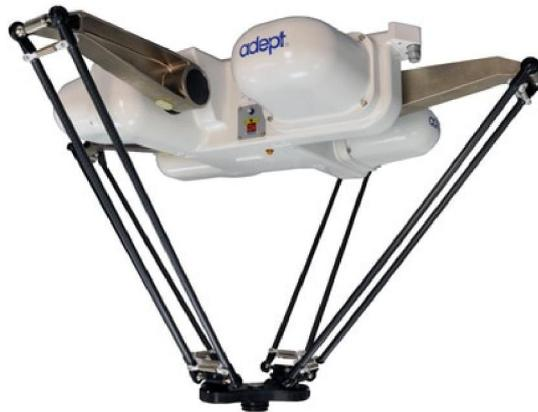
Ilustración 7: Ejemplo de un robot tipo delta. Fuente: <https://info.vinssa.com/robot-paralelo-adept-quattro-s800h>
