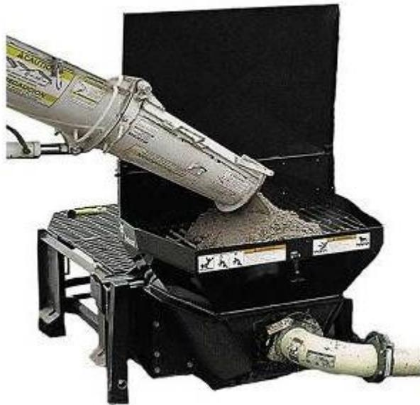
Ilustración 6: Bomba alimentadora. Fuente: <http://www.stackertractor.com>
