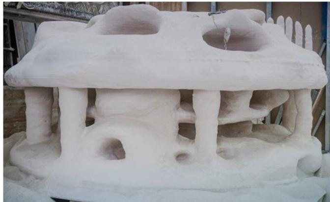
Ilustración 33: Arrecife artificial impreso en 3D mediante impresora tipo cartesiana modelo 'D-Shape'. Hecho por la empresa Boskalis. Fuente: <https://scubadiverlife.com/can-3d-printed-reefs-offer-relief-for-marine-life/>
