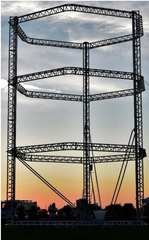
*Ilustración 15: Impresora 3D tipo delta, modelo 'BigDelta 12m'. Fuente: <https://www.3dwasp.com/en/giant-3d-printer-bigdelta-wasp-12mt/>*
