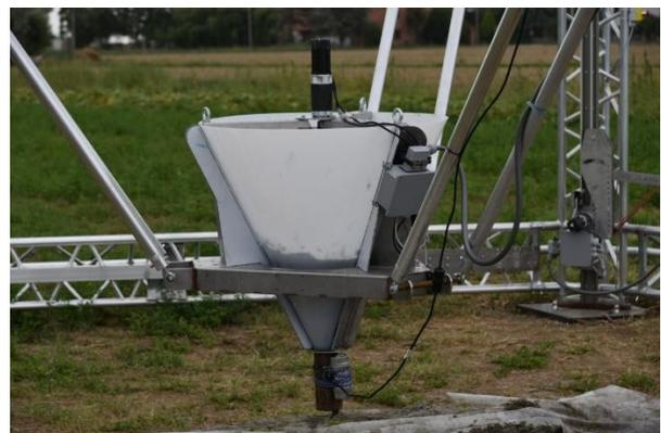
*Ilustración 17: Fotografía de la tolva correspondiente a la impresora 3D 'BigDelta 12m'. Fuente: <https://www.3dwasp.com/en/giant-3d-printer-bigdelta-wasp-12mt/>*
