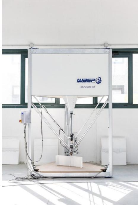
*Ilustración 9: Impresora 3D Tipo delta, modelo WASP 3MT. Fuente: <https://noumena.io/wasp-3mt/>*
