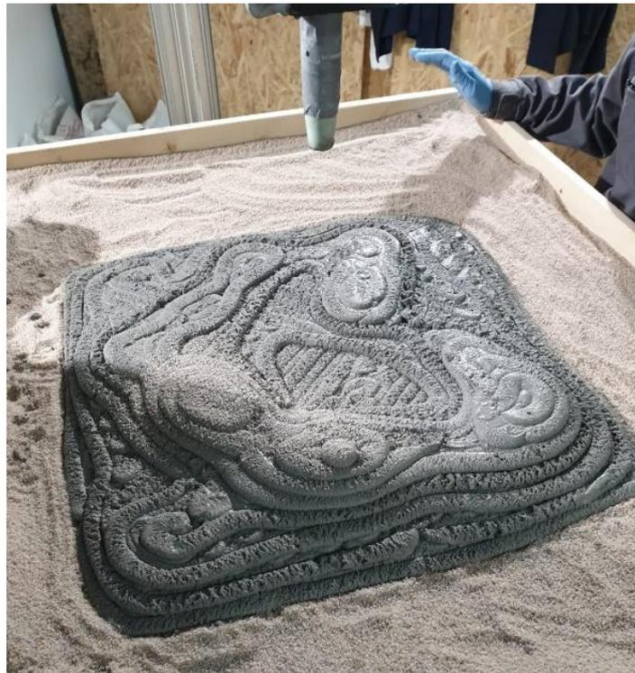
*Ilustración 12: Arrecife artificial de hormigón finalizado por impresión 3D mediante la impresora tipo delta modelo 'WASP 3MT', en la Universidad de Cantabria. Fuente: Propia.*
