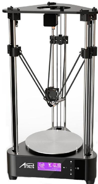
Ilustración 8: Ejemplo de una Impresora delta básica. Fuente: <https://lamejorimpresora3d.com/impresoras-3d/anet-a4>
