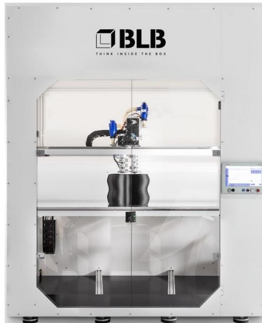
*Ilustración 20: Impresora cartesiana 'The Box Large' de la empresa BLB Industries. Fuente: <https://blbindustries.se/the-box-large-2/>*
