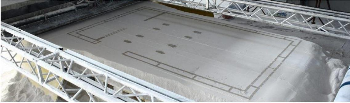
Ilustración 32: Impresora 3D cartesiana modelo 'D-Shape' empleando la tecnología 'binder-jetting' Fuente: <https://d-shape.com/what-is-it/>
