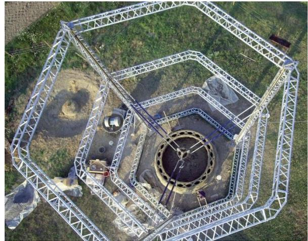
*Ilustración 16: Vista en planta de la impresora 3D tipo delta, modelo 'BigDelta 12m'. Fuente: <https://www.3dwasp.com/en/giant-3d-printer-bigdelta-wasp-12mt/>*
