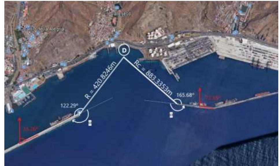
Imagen 6. Parámetros para el cálculo de la difracción
