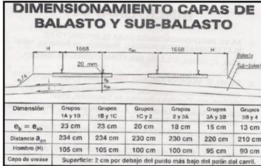
Figura 5.5. Dimensionamiento capas de balasto. [45]
