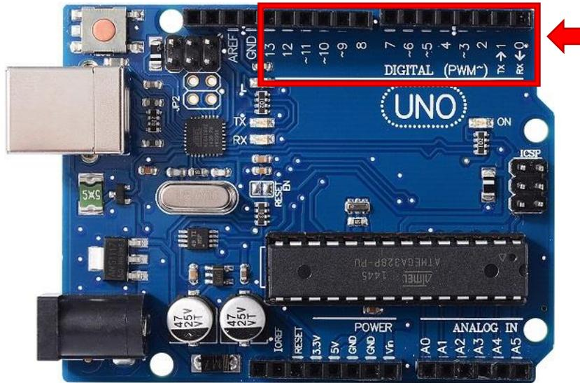
Figura 5-11 Salidas Digitales Arduino
