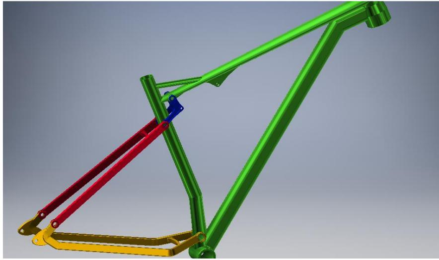
Se ha seleccionado un color distinto para cada elemento del cuadro con el fin de diferenciar más fácilmente donde se sitúa cada pieza. En cada unión entre piezas se situaría un rodamiento, ya que cada unión se trata de un par de rotación en el que cada pieza gira con respecto a su pieza contigua.
