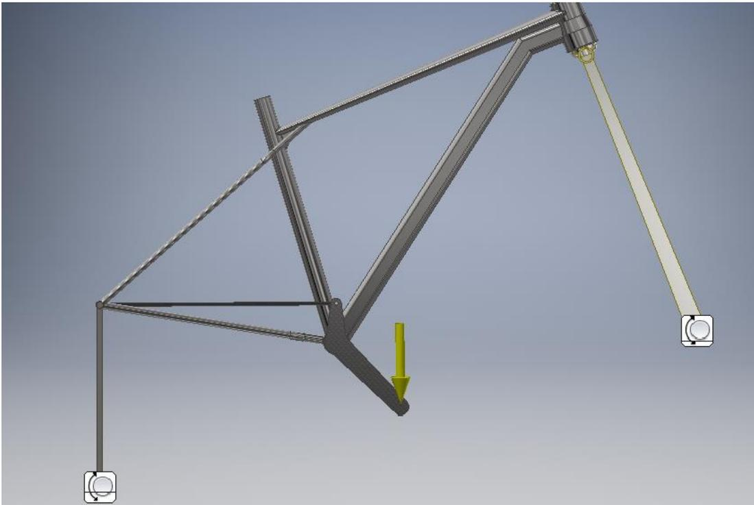
El montaje rígido que se mostraba en la figura de la norma no ha sido necesario modelarlo porque se ha impuesto una restricción de movimiento sin fricción en la parte inferior de la horquilla, lo que imposibilita el movimiento vertical de la misma, permitiendo únicamente el giro respecto al eje y.
