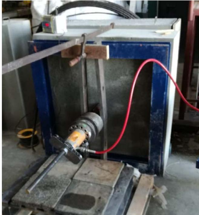
*Figura 37. Equipo utilizado para obtener la fuerza de arrancamiento.*
