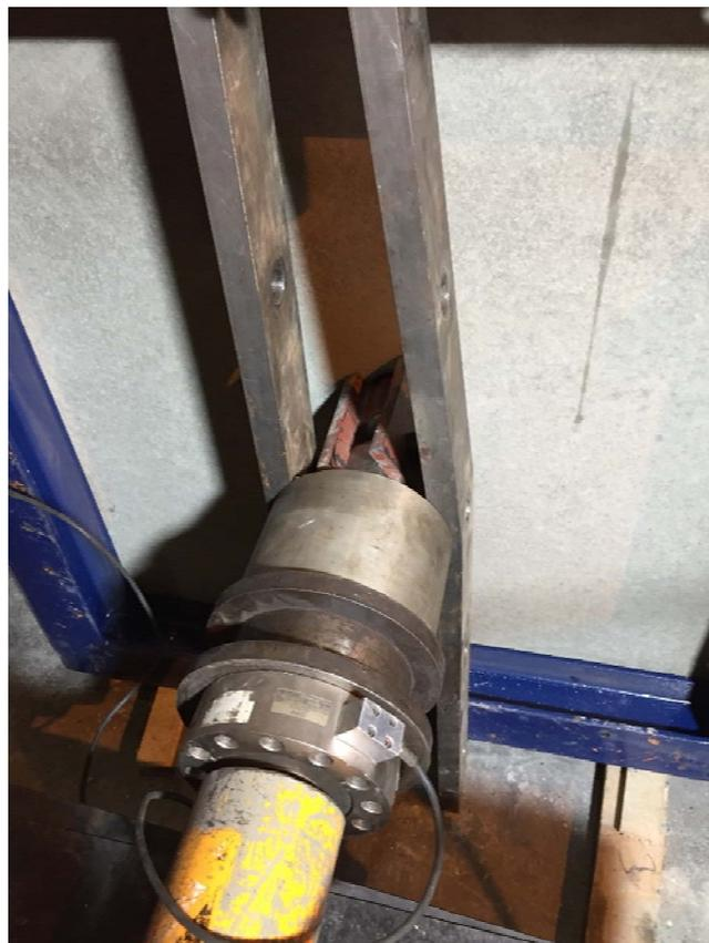
*Figura 38. Detalle de la célula de carga.*
