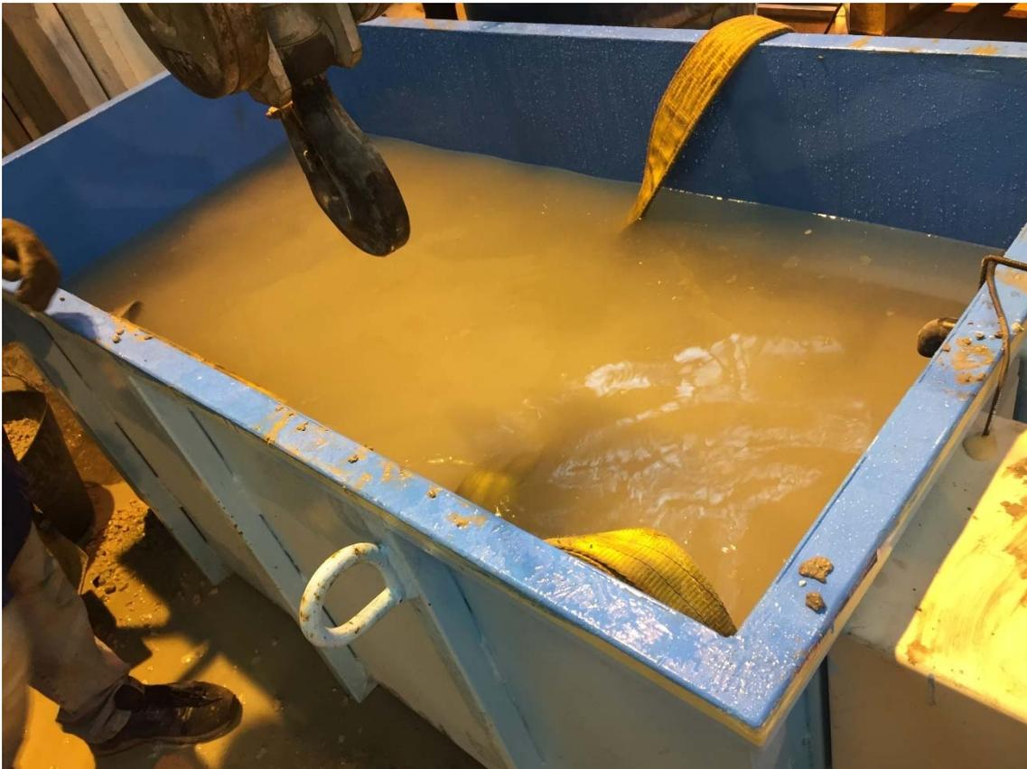
*Figura 28. Bañera para curado de probetas.*
