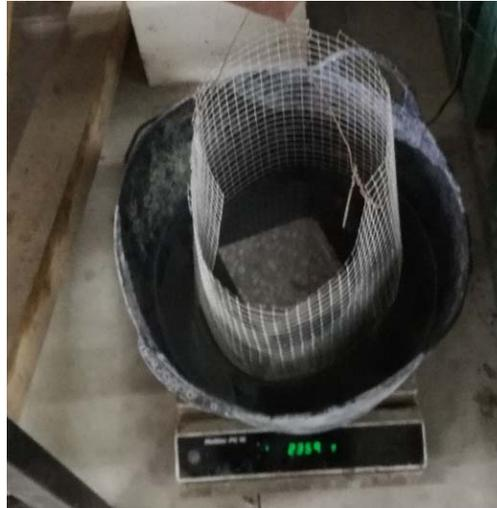
*Figura 32. Medida del volumen aparente de las muestras.*
