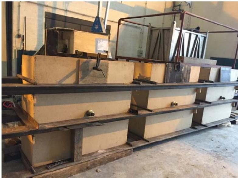
*Figura 26. Refuerzo de los moldes.*
