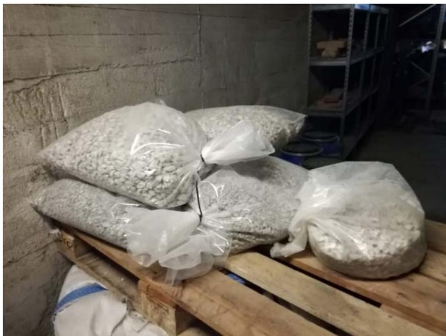
*Figura 15. Áridos calizos empleados en la fabricación del hormigón.*
