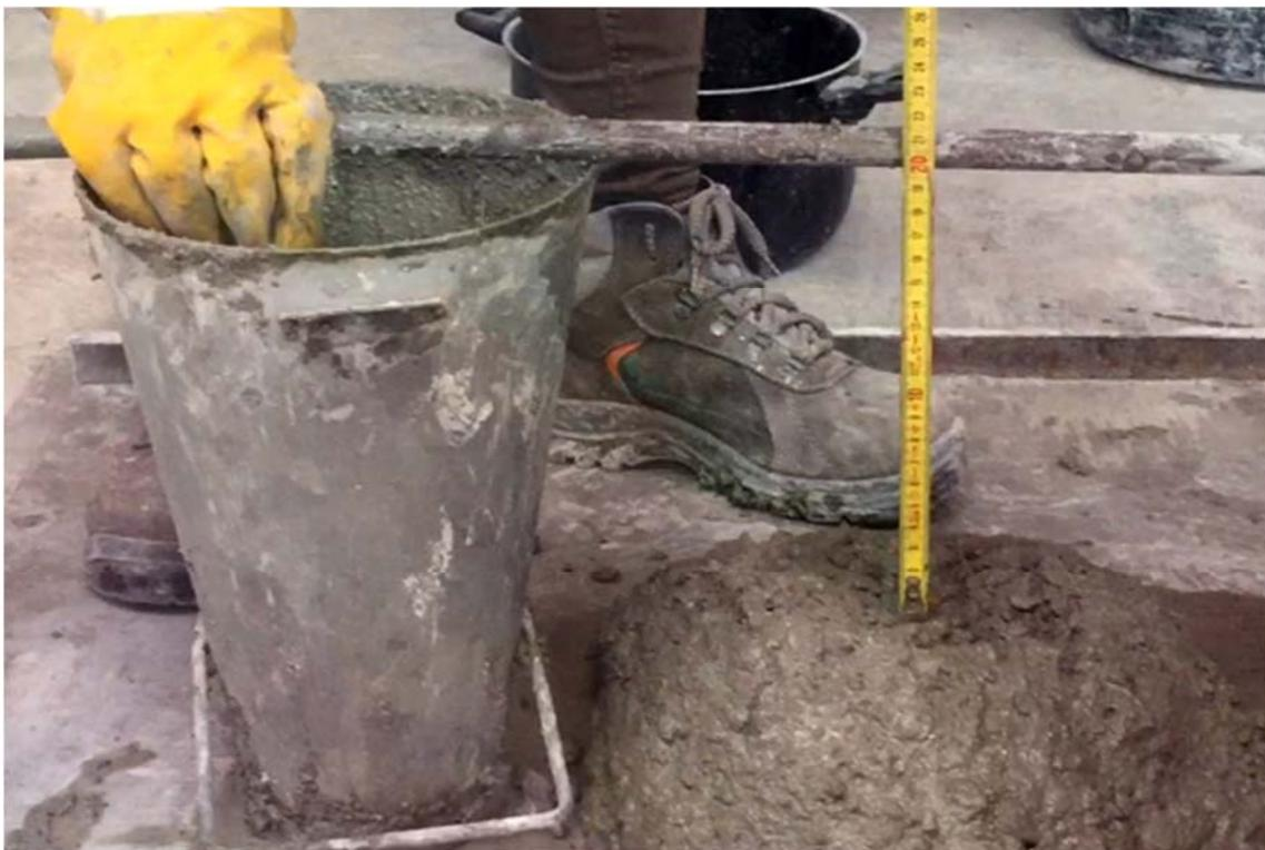
*Figura 22. Cono de Abrams de la primera dosificación.*
