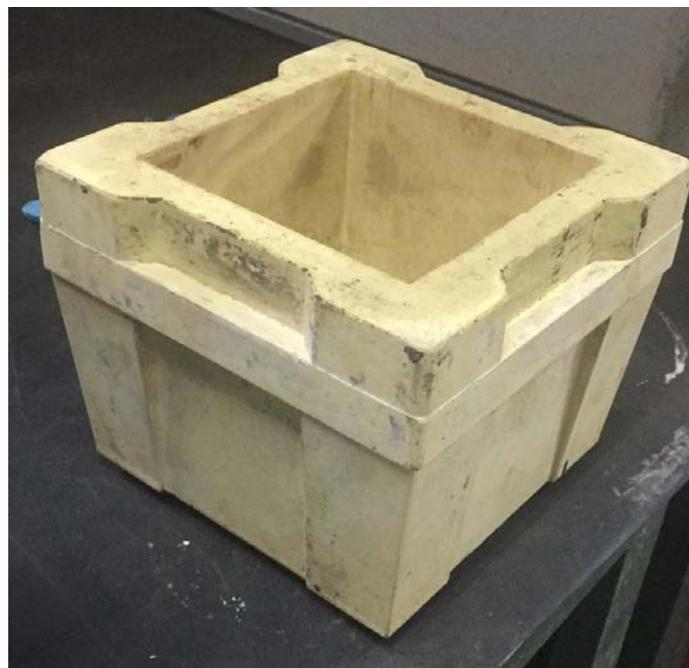
*Figura 24. Moldes para probetas cúbicas.*
