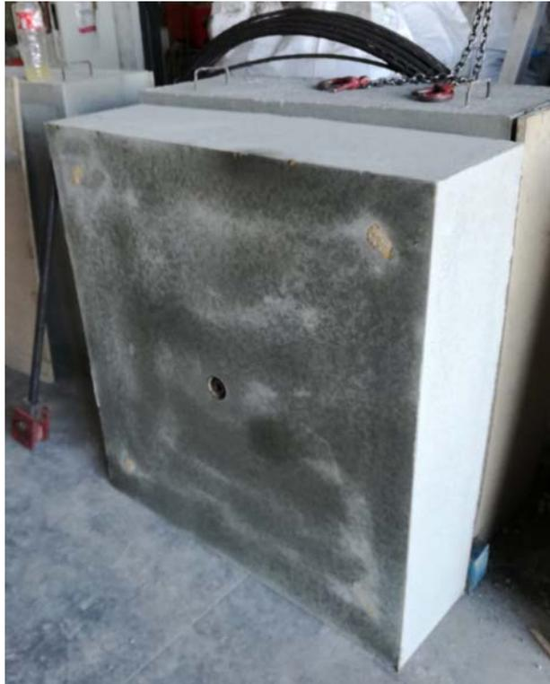
*Figura 36. Bloques para la determinación de la fuerza de arrancamiento.*
