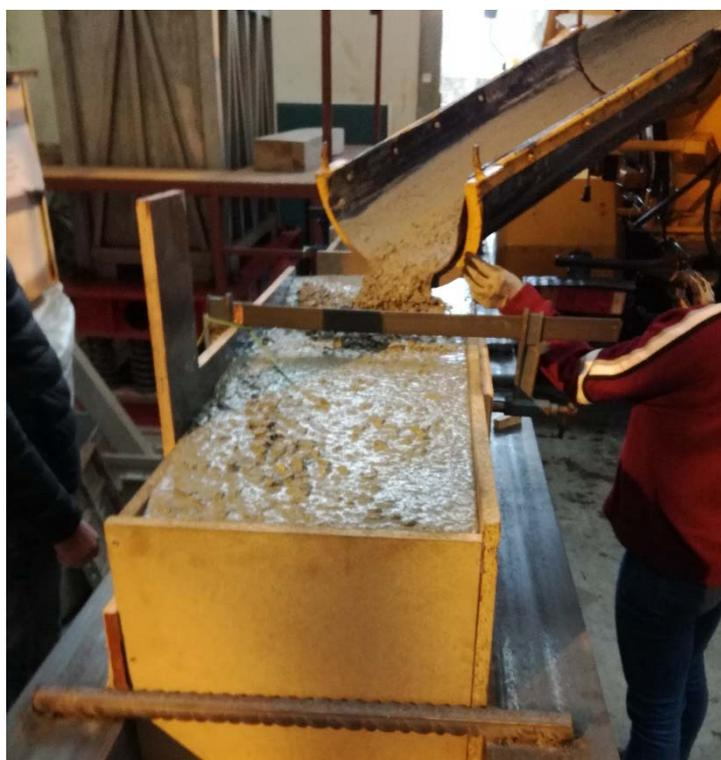
*Figura 27. Fabricación de probetas.*
