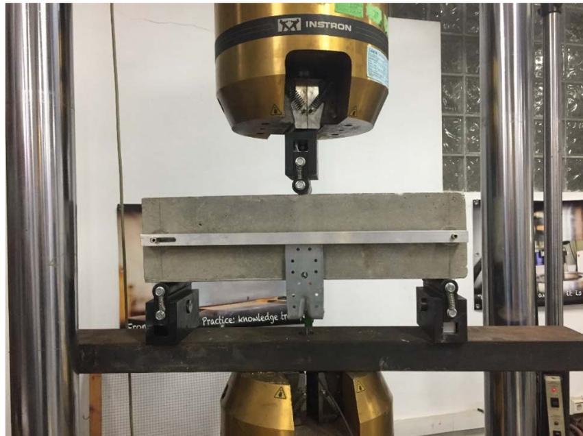
Figura 35. Ensayo a tracción por flexión.
