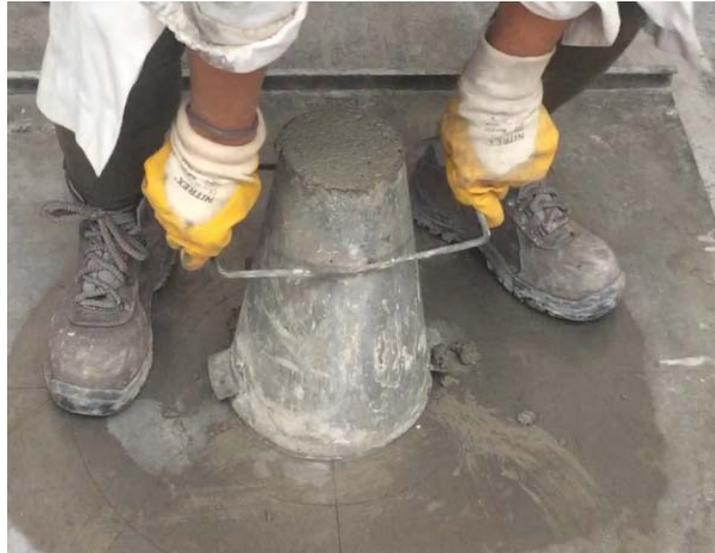
*Figura 29. Desarrollo del ensayo del cono de Abrams.*
