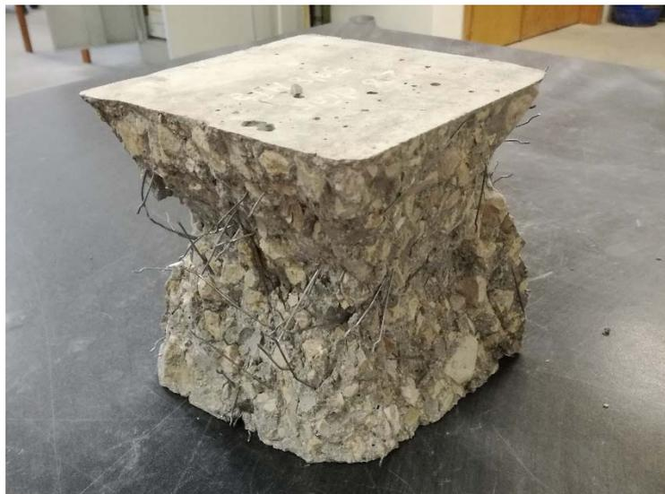
*Figura 40. Probeta tras ensayo de resistencia a compresión.*
