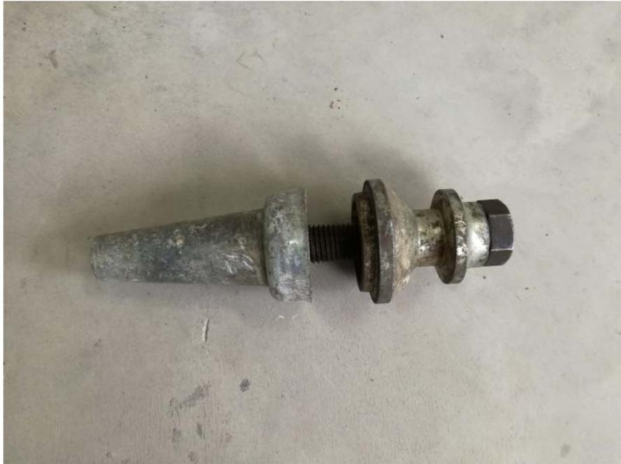
Figura 4. Anclaje empleado en los ensayos.
