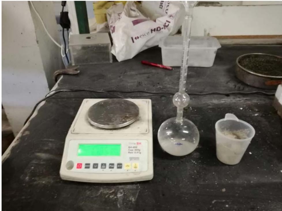
*Figura 14. Material para la determinación de la densidad del cemento.*
