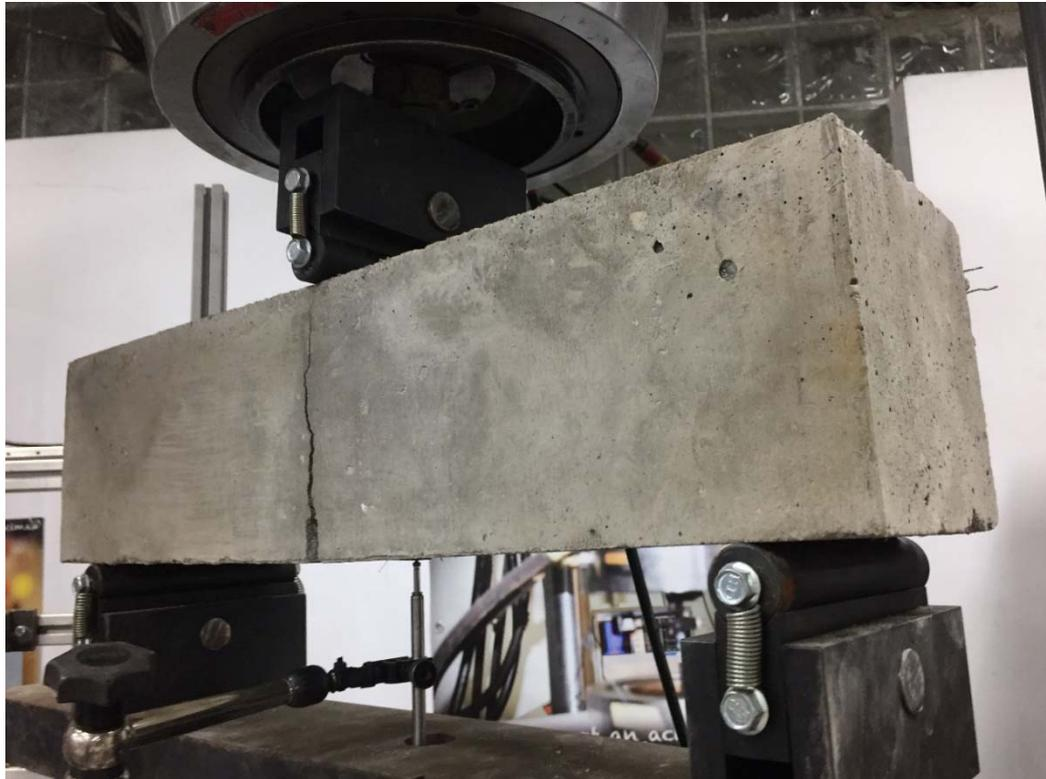
Figura 41. Probeta tras el ensayo a tracción por flexión.
