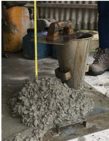
Figura 39. Ensayo del cono de Abrams.
