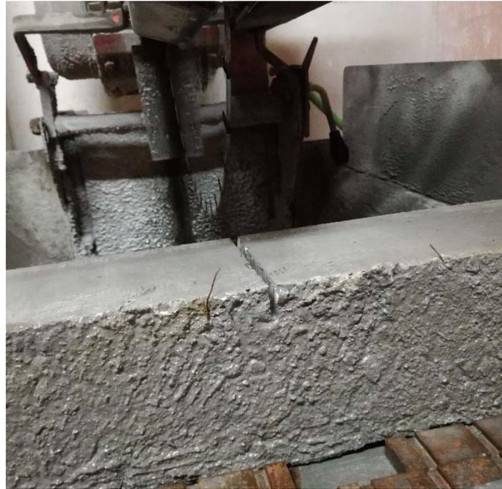
*Figura 34. Realización de la entalla para ensayo de flexión.*
