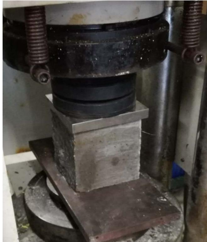
*Figura 33. Equipo empleado para el ensayo de resistencia a compresión.*
