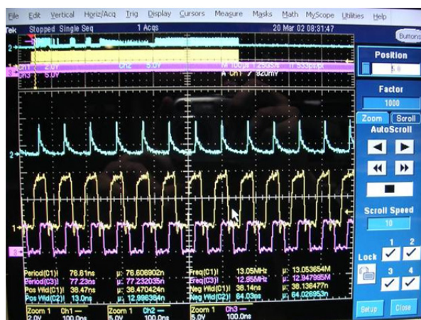
Figura 120 – Proceso de sincronización en recepción señal del detector de fase | datos recibidos | señal de reloj
