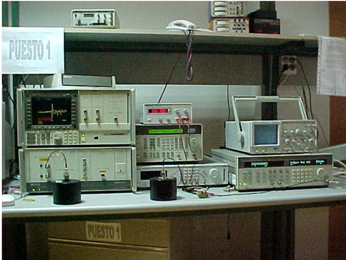
Figura 62 – Bancada de medida en laboratorio para pruebas radiadas
