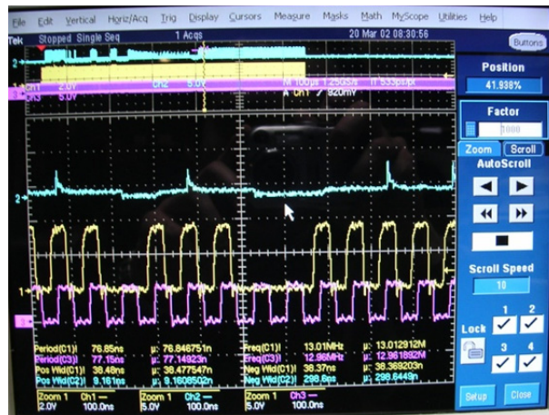
Figura 121 – Sincronización en recepción completada señal del detector de fase | datos recibidos | señal de reloj
