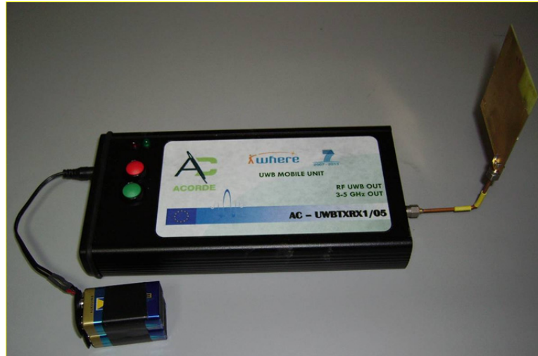
Figura 129 – Prototipo final IR-UWB ensamblado, alimentado a baterías
