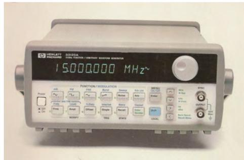
Figura 2.14: Generador de funciones HP 33120A
