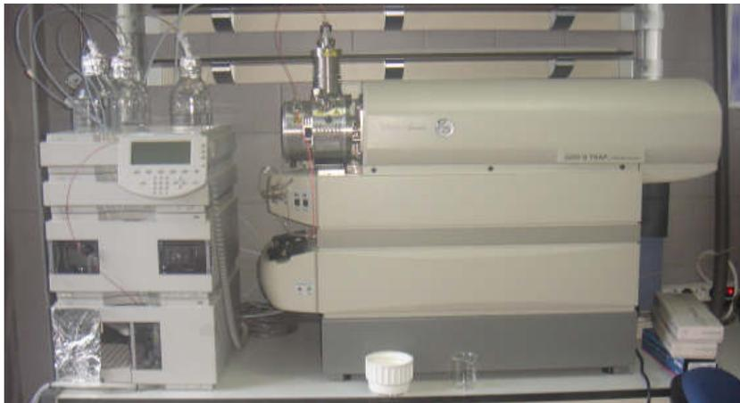
**Fig. 3.21** Cromatógrafo LC-QTrap MS/MS.
