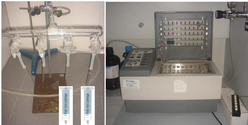
**Fig. 3.23** Sistema de secado de cartuchos y evaporador Turbo-Vap.
