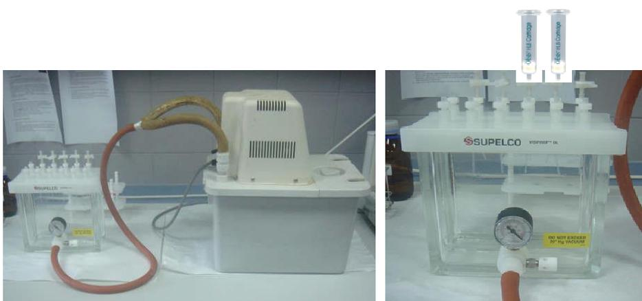
**Fig. 3.22** Sistema manual de extracción en fase sólida.
