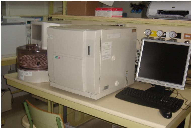
**Fig. 3.5** Analizador automático de carbono COT-V-CPH Shimadzu con muestreador ASI.
