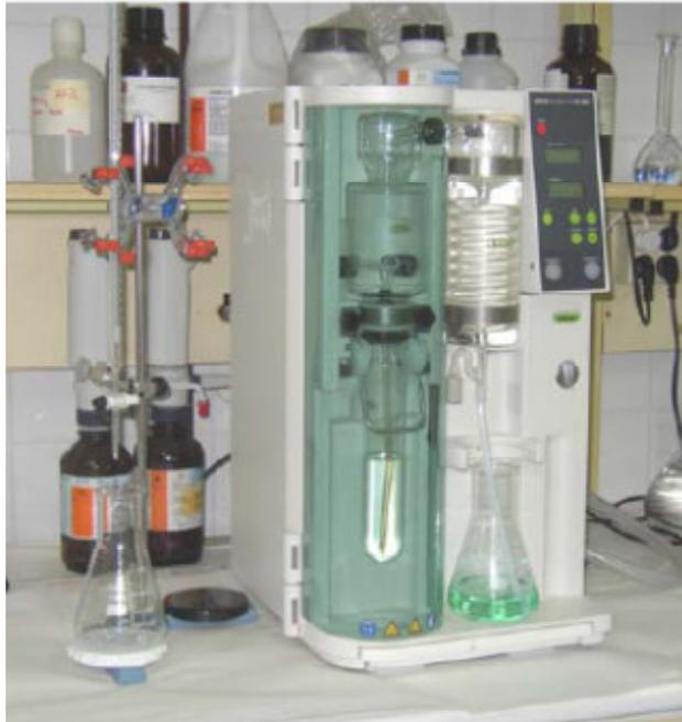
**Fig. 3.18** Destilador semi-automático para la determinación de  $N\text{-NH}_4^+$ .
