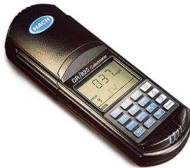
**Fig. 3.19** Colorímetro portátil para la determinación de cloro libre.
