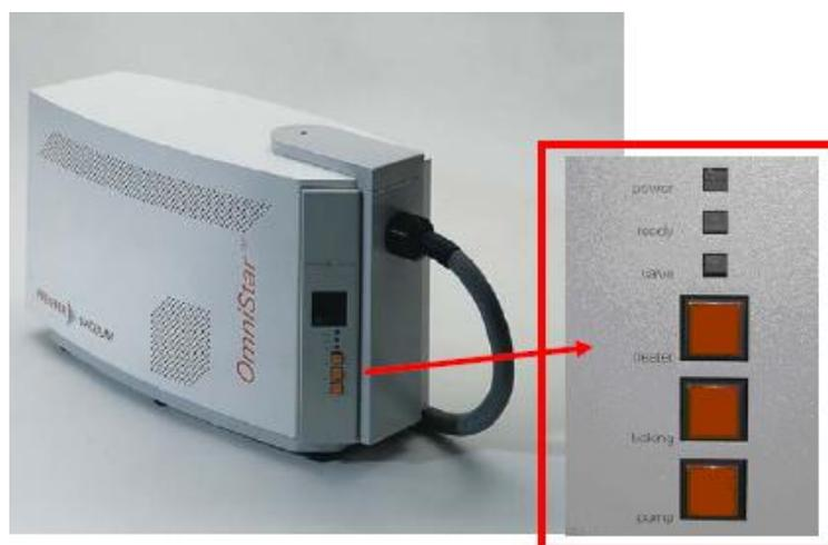
**Figura 2.3: Espectrómetro de Masas**
