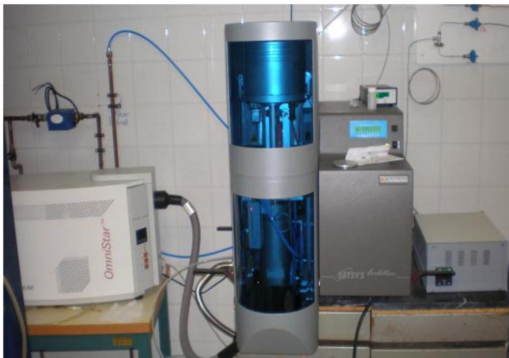
**Figura 2.1: Equipo termogravimétrico conectado en serie a un espectrómetro de masas**
