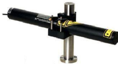
Figura 4.5 Láser He-Ne utilizado en las medidas
