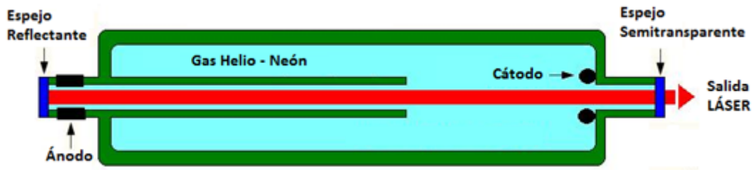
Figura 4.6 Representación del funcionamiento del Láser He-Ne
