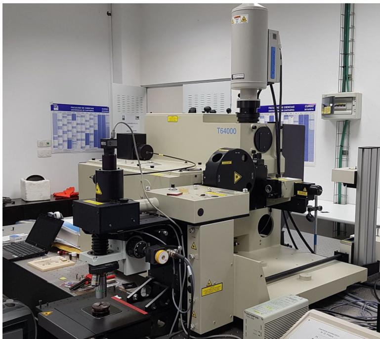
Figura 18: Raman T6400 de Jobin Yvon utilizado para la realización de las medidas de luminiscencia del  $\text{Er}_2[\text{Pt}(\text{CN})_4]_3 \cdot 21\text{H}_2\text{O}$  bajo presión.
