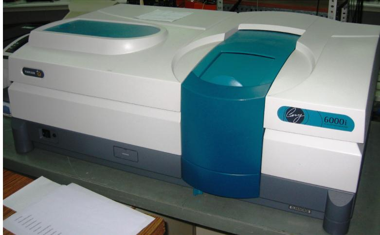
Figura 16: Espectrofotómetro de doble haz de haz Cary 6000i que se usó para obtener los espectros de absorción de las diferentes muestras en condiciones ambiente.
