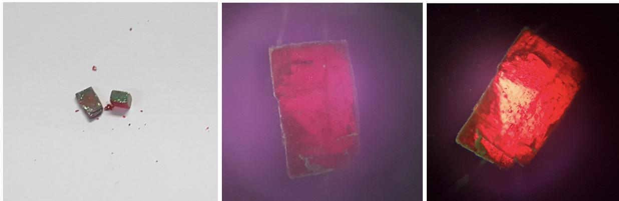
Figura 19: Monocristal del compuesto  $\text{Er}_2[\text{Pt}(\text{CN})_4]_3 \cdot 21\text{H}_2\text{O}$  entre polarizadores cruzados.
