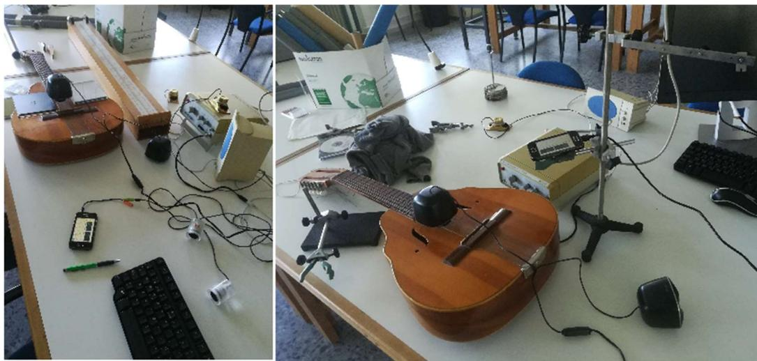
Figura 3.4: Laúd suspendido para hacer medidas de sus modos con el mínimo impedimento material posible.
