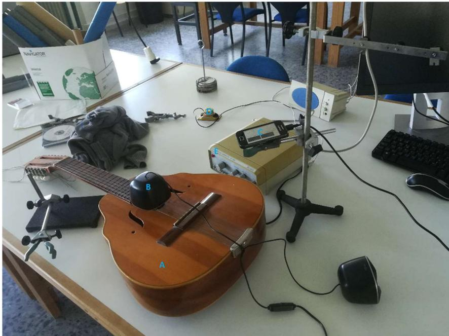
Figura 3.1: Montaje experimental para la detección de modos de vibración de la caja e interior de un instrumento. En este caso, el sujeto es un laúd. Se indican con letras azules los distintos componentes del montaje, que se explican en el texto.
