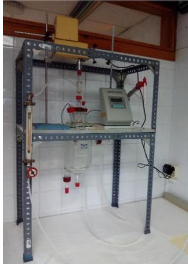
Figura 2. 10: Fotografía del sistema experimental de carbonatación acelerada.
