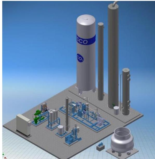
Figura 2. 19: Instalación de concentración de CO<sub>2</sub> de ASCOSORB.
