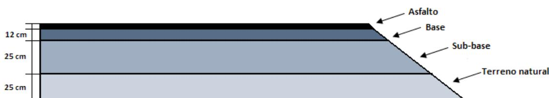
Figura 2. 30: Sección de una carretera, donde se ven las capas de las que está formada.
