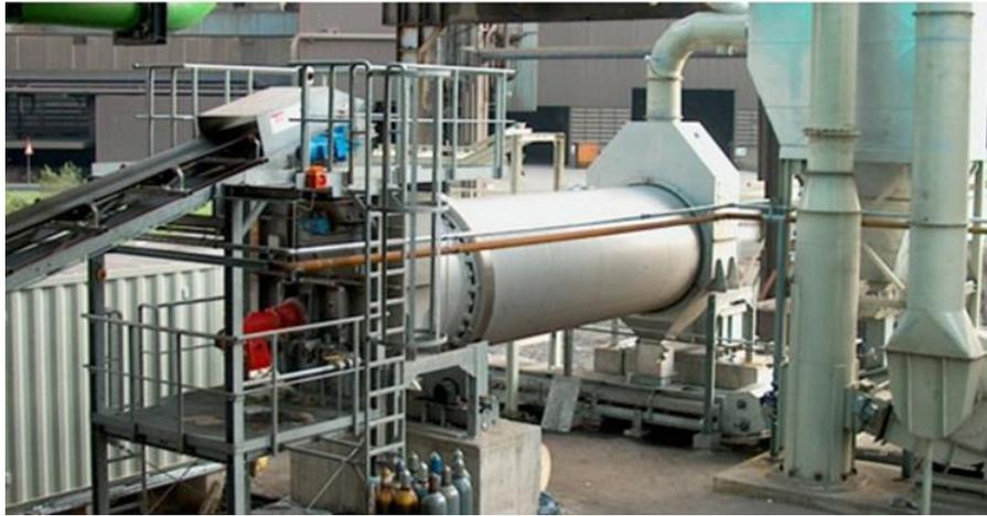
Figura 2. 28: Secador de tambor de doble carcasa.
