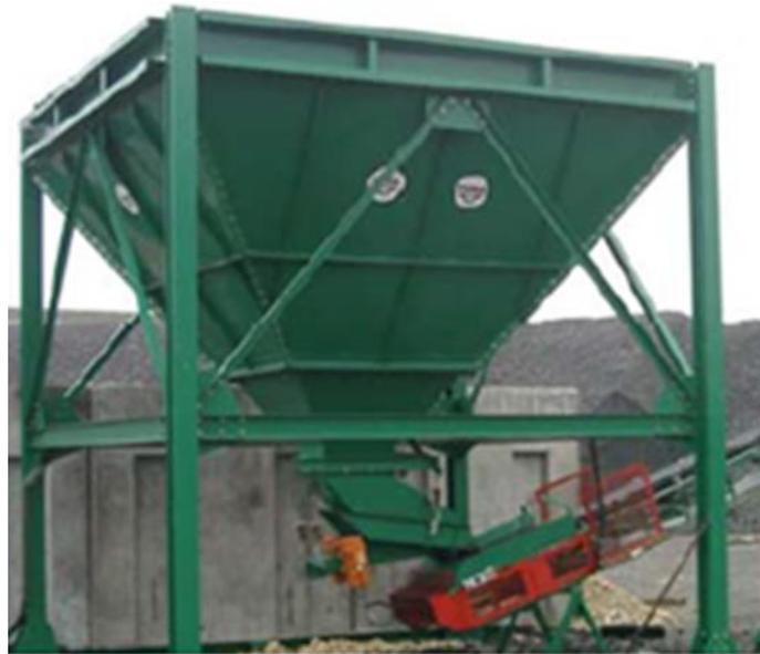
Figura 2. 27: Tolva de almacenamiento de cenizas carbonatadas.
