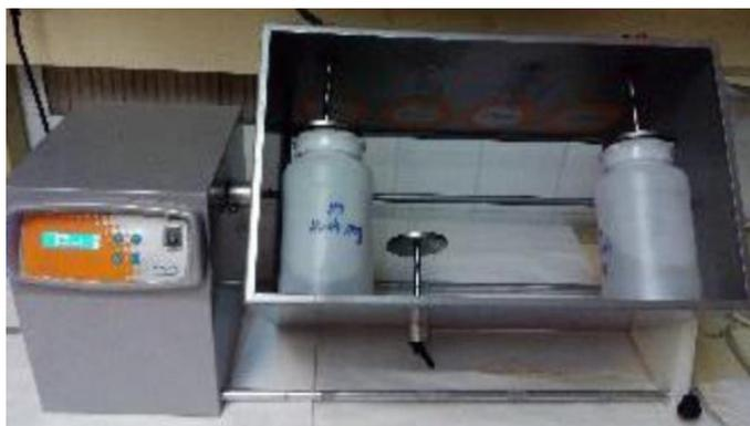
Figura 2. 11: Equipo utilizado para los ensayos de lixiviación.
