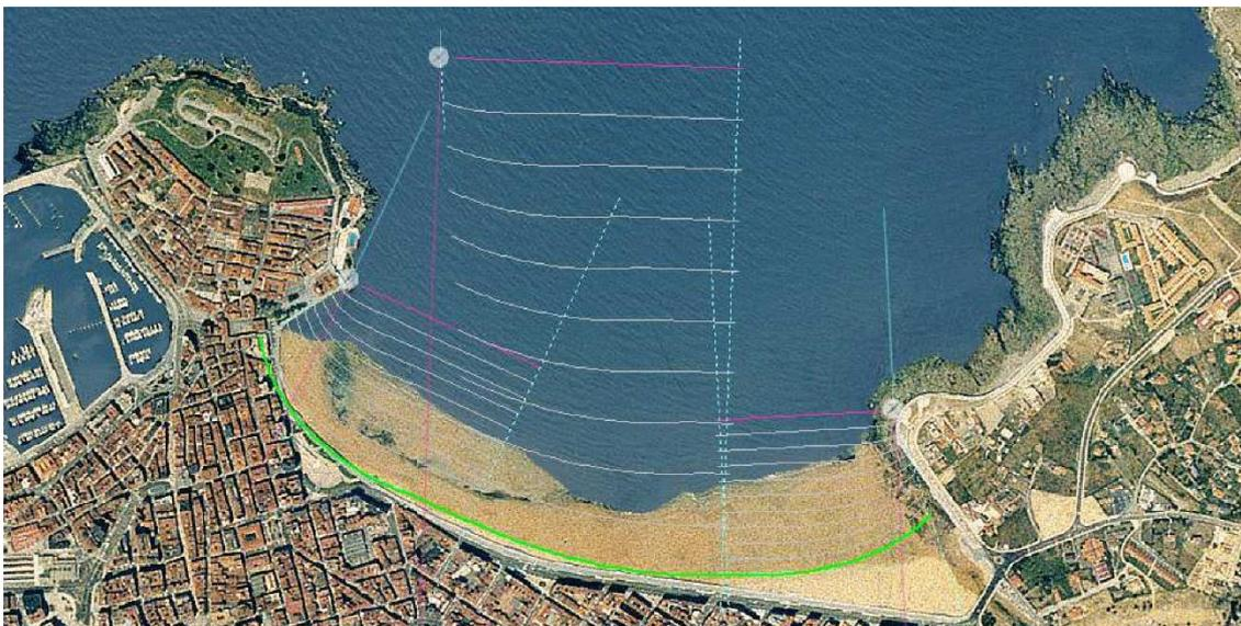
*Ilustración 24 - Ajuste de la planta de la playa de San Lorenzo previo a la ampliación del puerto*
