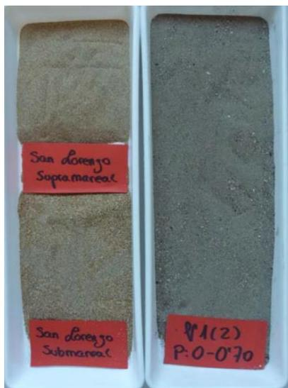
Ilustración 11 - Comparativa entre la arena nativa de la playa de San Lorenzo y el material del vibrocorer V1 de la ensenada de Gijón
