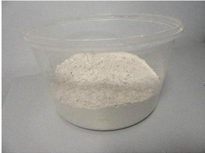
Figura 4-12: Filler calizo empleado en la colmatación.
