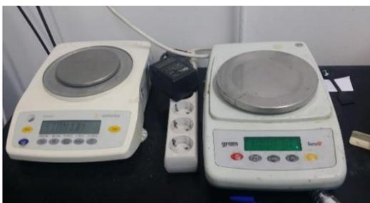
*Figura 4-1: Balanzas empleadas en la determinación de la masa por unidad de superficie.*
