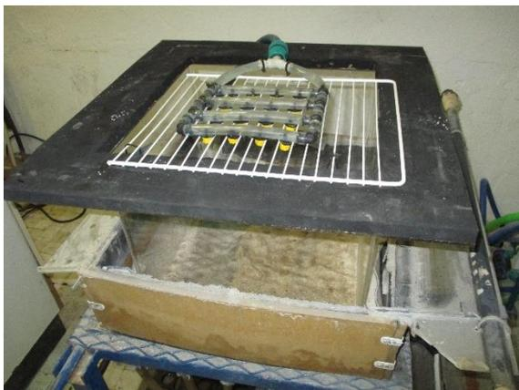
Figura 4-8: Montaje para ensayo de colmatación. Parte superior.
