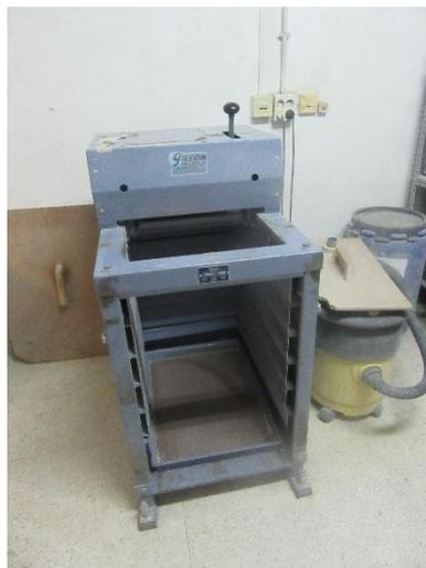
Figura 4-7: Tamizadora empleada en el análisis granulométrico del árido calizo.
