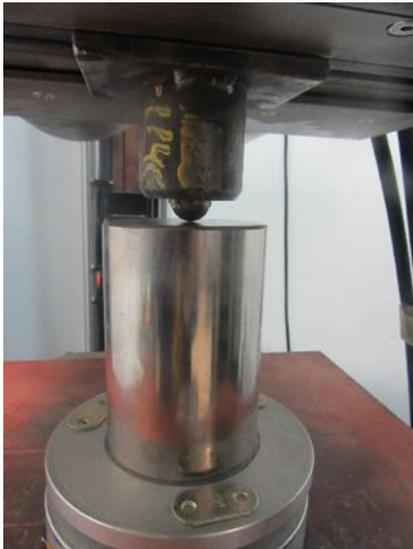
*Figura 4-4: Ensayo de espesor de capas individuales. Procedimiento B (Carga incremental de probetas individuales).*
