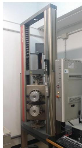
*Figura 4-2: Máquina de ensayos universal estática.*
