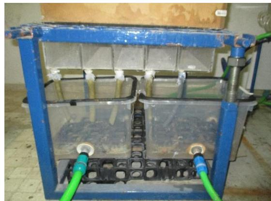
Figura 4-9: Montaje para ensayo de colmatación. Parte inferior.
