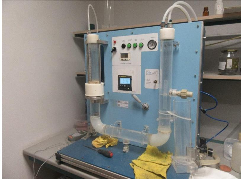
Figura 4-15: Aparato de ensayo en laboratorio de permeabilidad al agua perpendicular al plano sin carga, de flujo vertical.
