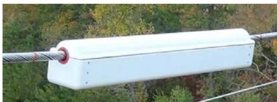
Figura 2.4.7 Reactancia de línea en una línea de transmisión (Fuente y adaptado de: [4])
