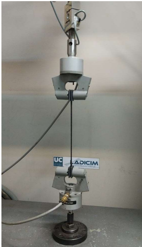
Fig. 15. Ensayo tracción probetas polietileno reciclado.
