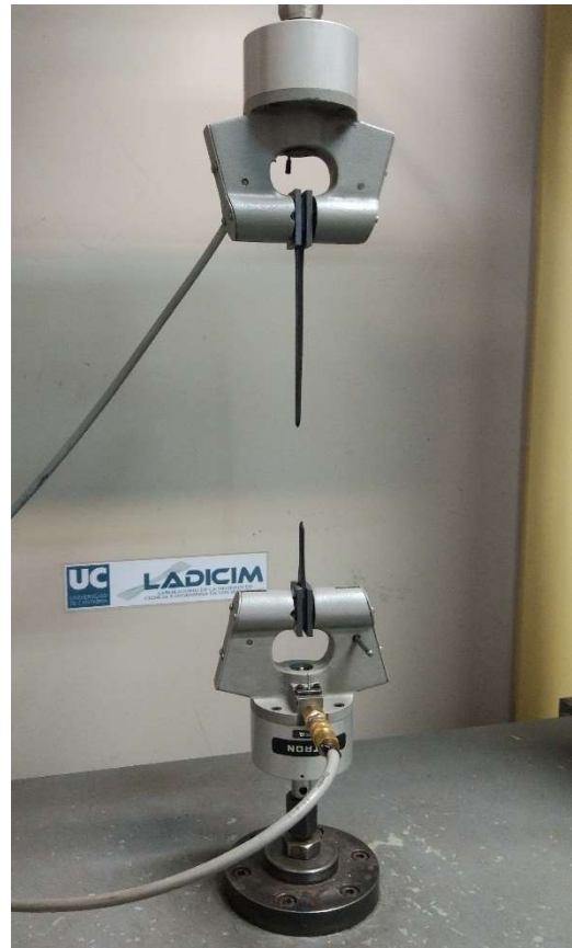
Fig. 15. Ensayo tracción probetas polietileno reciclado.
