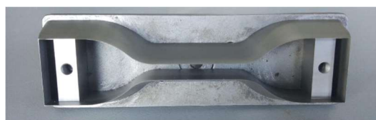
Fig. 12. Cuchilla con forma de probeta de halterio normalizada.
