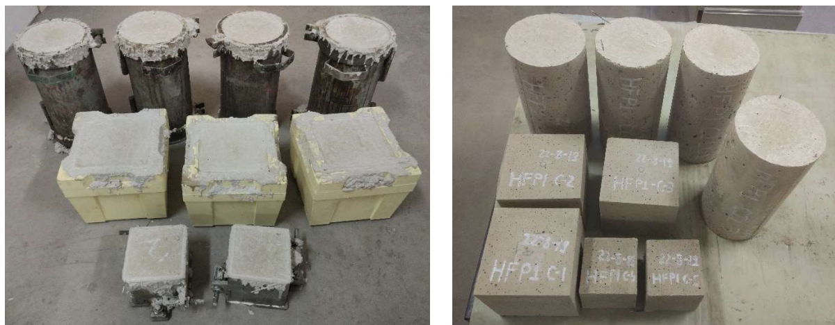
Fig. 25. Fabricación probetas normalizadas (izq.) y probetas desmoldadas y etiquetadas (dcha.).
