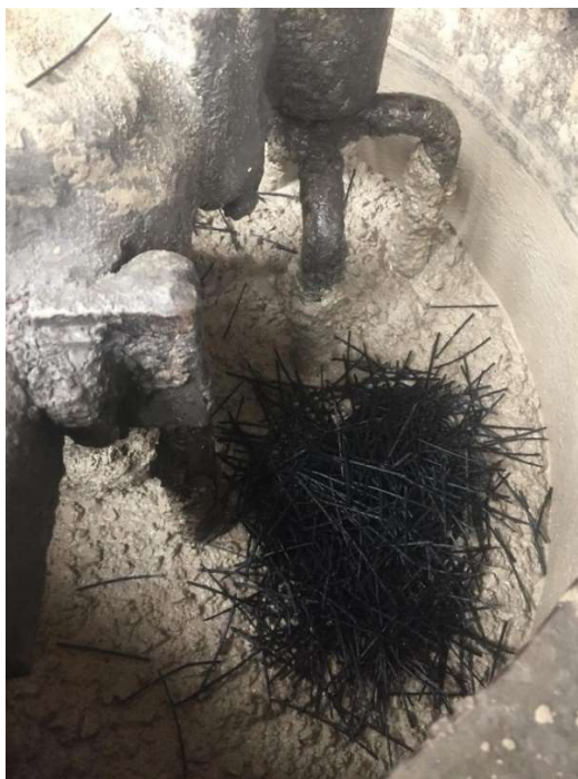
Fig. 24. Incorporación de las fibras en el hormigón.
