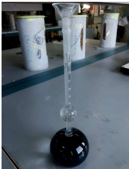
Fig. 9. Determinación de la densidad del polietileno mediante el picnómetro Le Chatelier.
