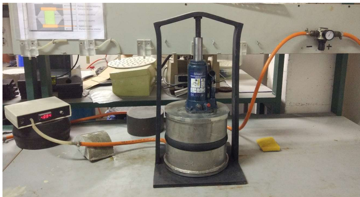
Fig. 30. Disposición del ensayo de permeabilidad al oxígeno.
