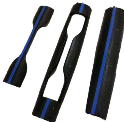
Fig. 13. Troquelado tuberías con la prensa (izq.) y obtención de probetas normalizadas (dcha.).
