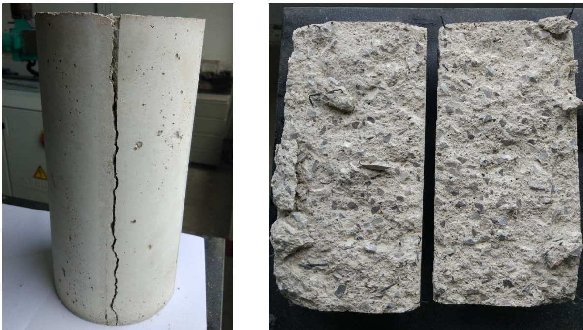
Fig. 48. Resultado de la probeta sometida al ensayo tracción indirecta (izq.) y probeta partida por la mitad posteriormente para comprobar la adherencia de las fibras (dcha.)
