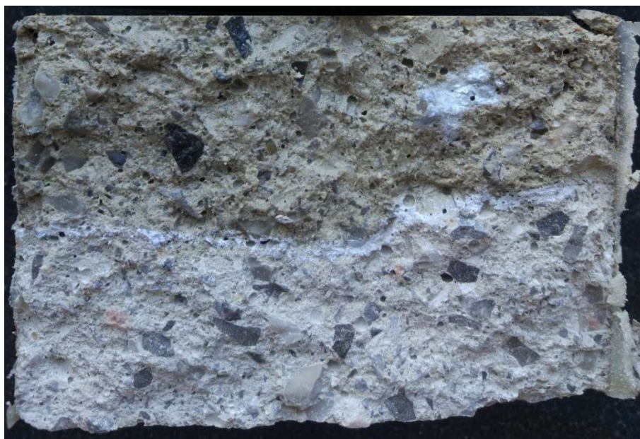
Fig. 32. Ejemplo de la huella de humedad dejada por el agua.
