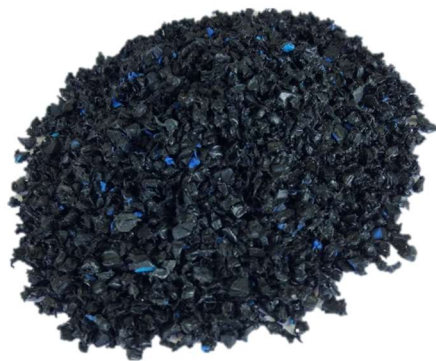
Fig. 6. Granza de polietileno obtenida de la trituración de tuberías.
