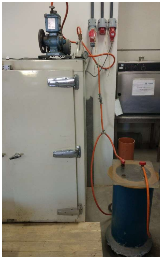
Fig. 28. Esquema del dispositivo de vacío para el ensayo de densidad.
