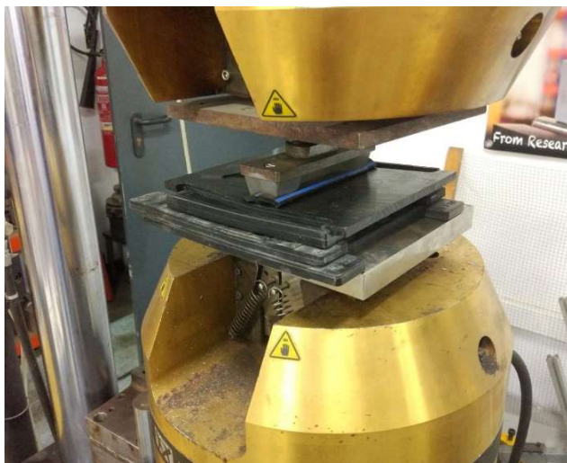
Fig. 13. Troquelado tuberías con la prensa (izq.) y obtención de probetas normalizadas (dcha.).
