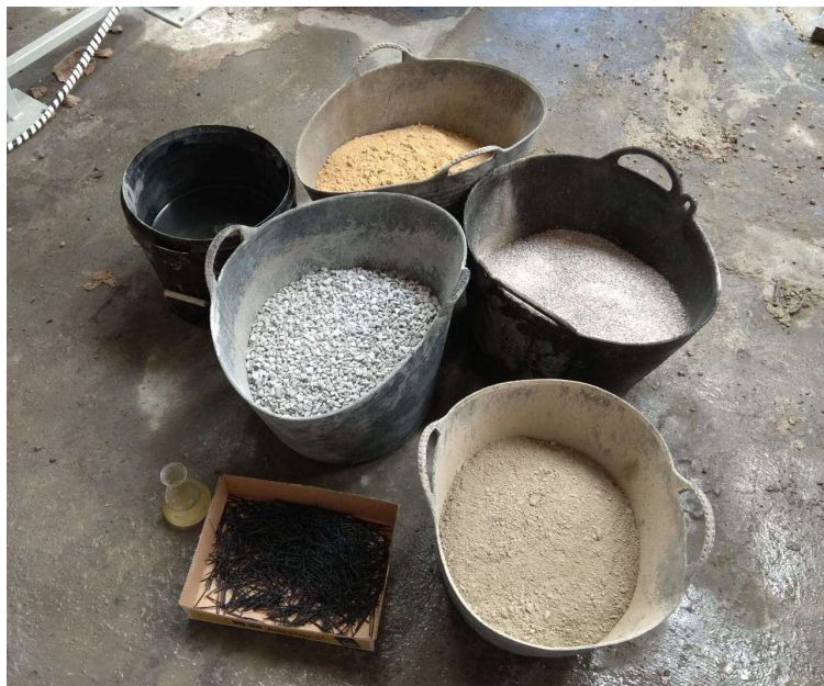
Fig. 23. Materiales usados para la fabricación del hormigón con fibras.
