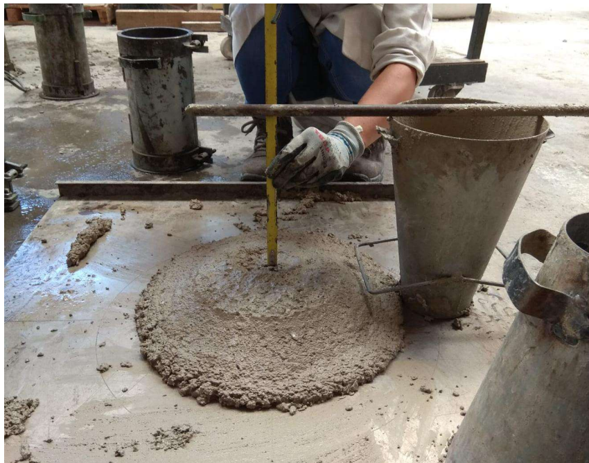
Fig. 26. Medida de la altura del cono de Abrams.
