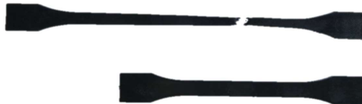
Fig. 16. Resultado probeta rota mediante ensayo de tracción.
