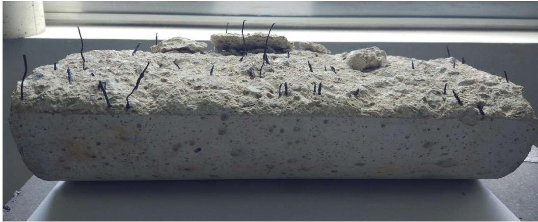
Fig. 50. Ejemplo de la dirección en las que se disponen las fibras.
