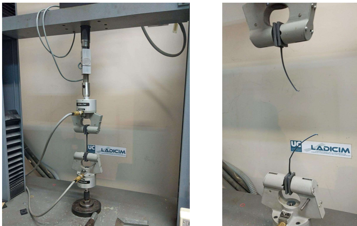
Fig. 10. Ensayo de tracción con la máquina de ensayos SERVOSIS.
