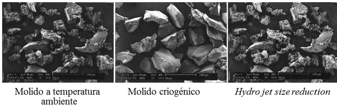
Figura 2-3. Partículas de polvo de NFU generadas mediante distintos procedimientos. SEM análisis. Barra de escala de 200 µm. Adaptado de [126]
