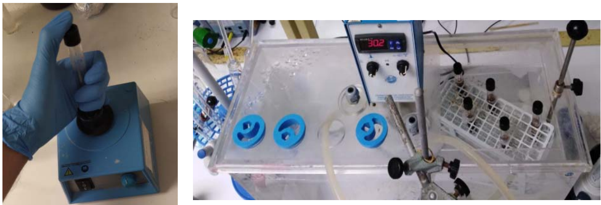
figura 17. Baño a 30°C (derecha), vortex (izquierda)
