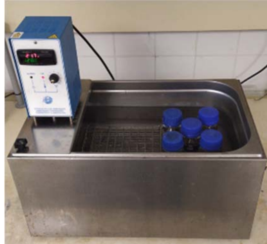
figura 18. Baño de silicona a 120°C con los vasos iso cerrados
