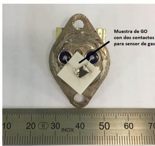
Figura 15: Muestra soldada al conector por medio de dos contactos.
