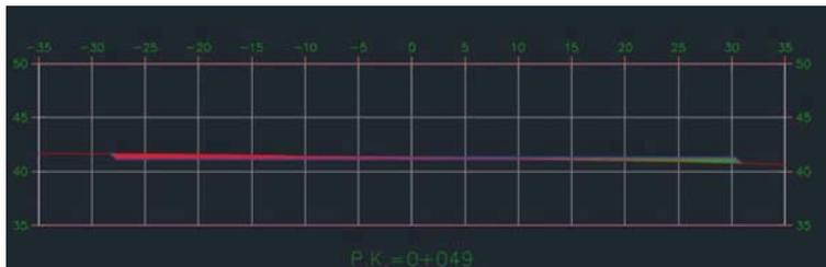
Figura 1. Perfil transversal explanada P.K. 0+049
