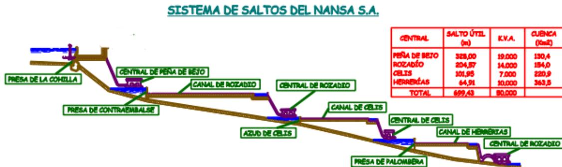
Figura 16: Perfil longitudinal de los Saltos del Nansa 13
