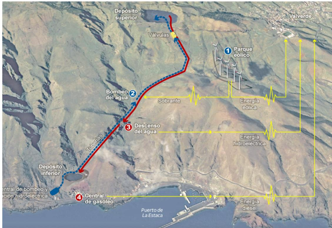
Figura 79: Esquema del funcionamiento de la central hidroeléctrica del Hierro 23
