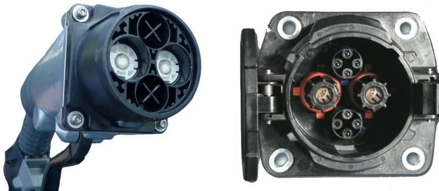
Figura 2.6 – Conector CHAdeMO (izquierda). Base de conector CHAdeMO (derecha).
