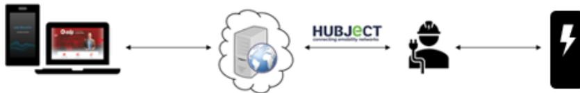
Figura 6.3 – Esquema de comunicación del sistema en 'Recarga tipo 2'. Acceso usuario (extremo izquierdo), servidor central EDP (izquierda), conexión a través de la plataforma Hubject con el operador del PdR (derecha), Punto de Recarga (extremo derecho).
