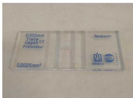
**Figura 5:** Cámara de Neubauer utilizada para el recuento celular.
