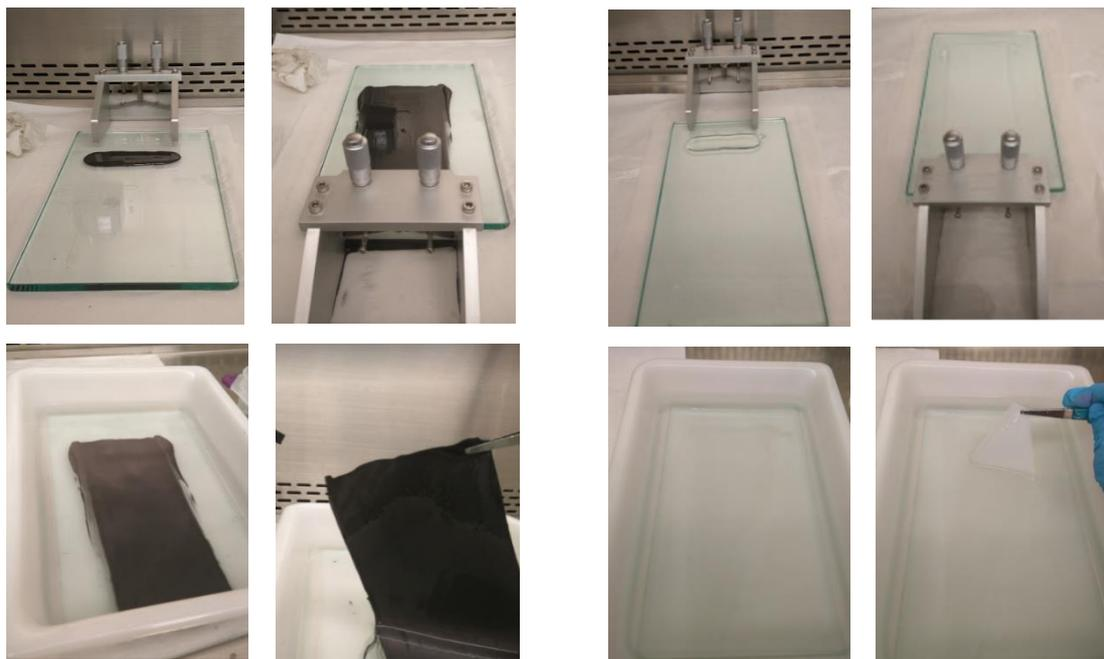
**Figura 2:**Técnica de inversión de fases y proceso de casting para membranas PAN/G.
