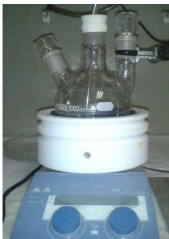
Figura 2.3. Equipo experimental para la síntesis de las partículas magnéticas (MAG).
