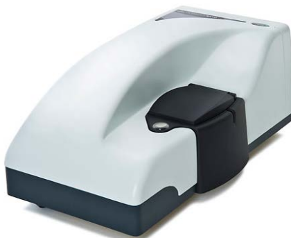
Figura 2.9. Zetasizer Nano ZS de la casa Malvern.
