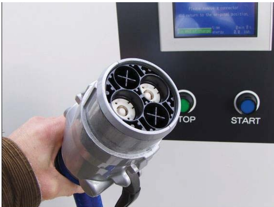
Ilustración 4 Conector CHAdeMO Fuente (21)
