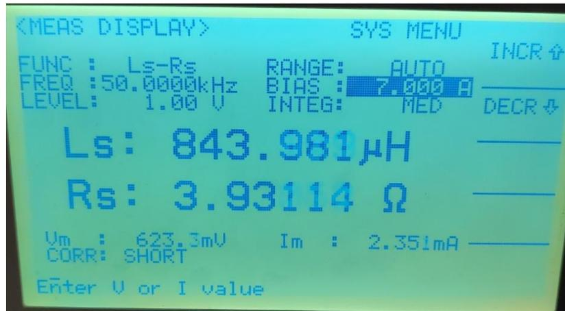
**Fig. 41.** Inductancia de la bobina  $L_1$  a 50 kHz atravesada por 7 A de corriente DC
