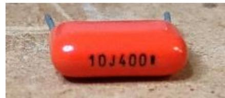
**Fig. 24. Condensador  $C_{1.2}$**
