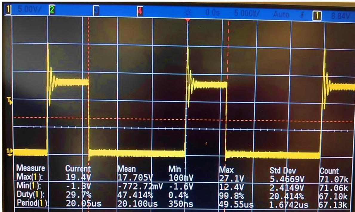
**Fig. 52. Tensión puerta fuente en el transistor. Escalas: eje Y – 5V, eje X – 5µs**
