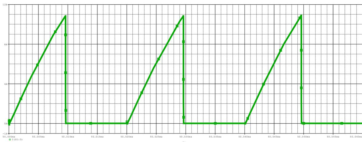
**Fig. 30. Corriente a través del MOSFET para potencia de entrada máxima**
