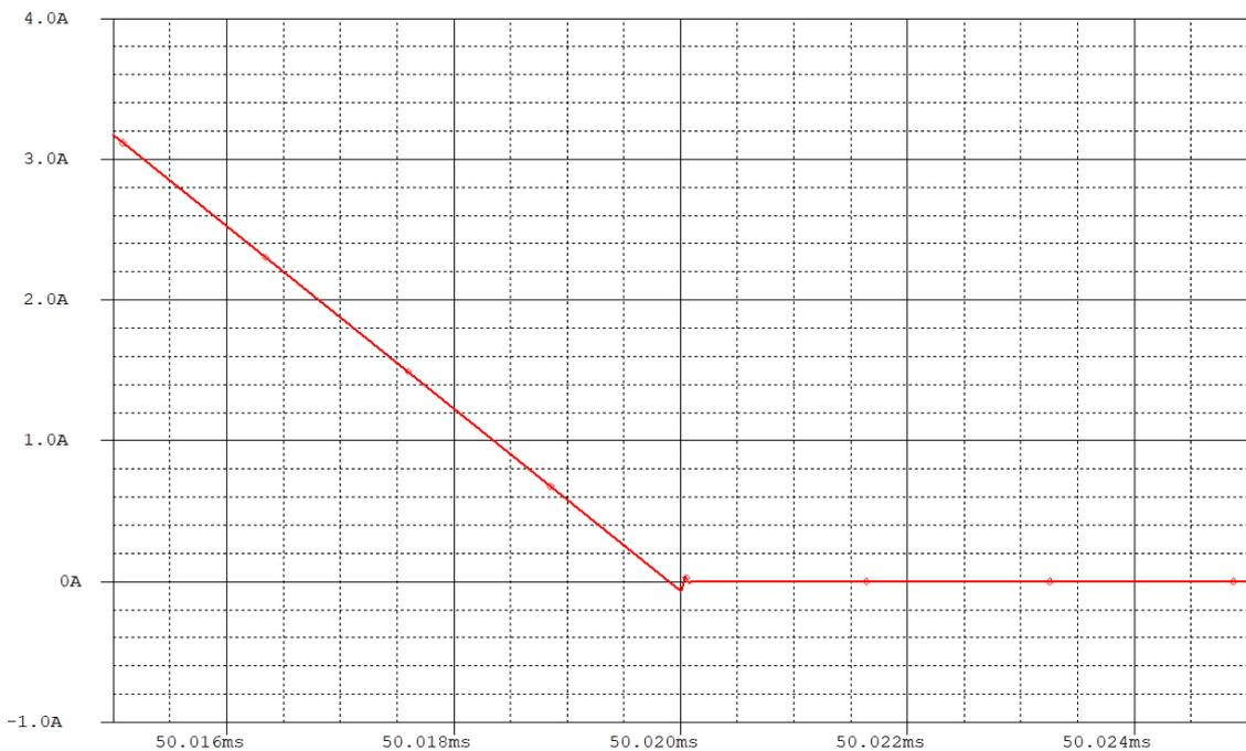
**Fig. 14. Corriente a través del diodo ampliada al final del periodo de conmutación**
